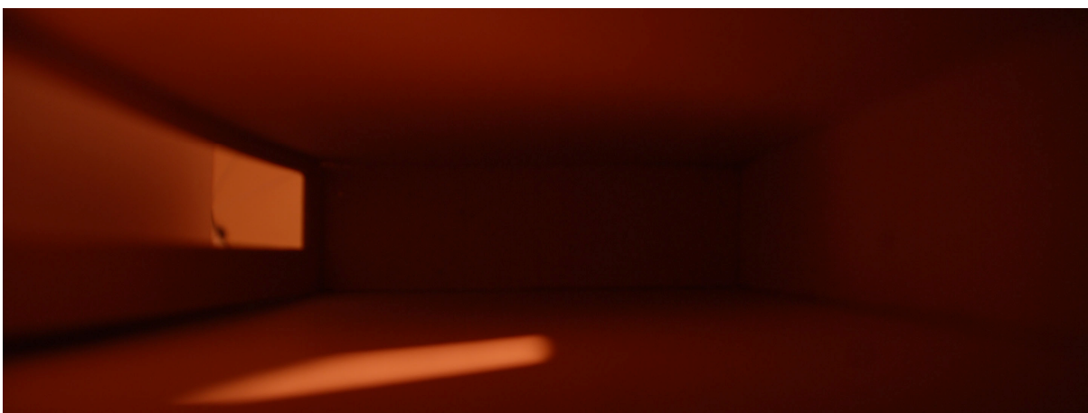
Figura 58 – Exemplo de resultado visual obtido com simulação de projeção de sombras no interior da ocupação-padrão com o equipamento Heliodon.
