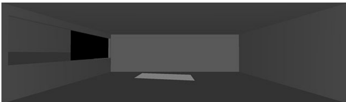
Figura 62 – Exemplo de resultado visual obtido com simulação de projeção de sombras no interior da ocupação-padrão com o programa AutoCAD.
