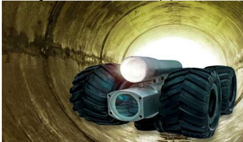
Fotografia 4 - Sistemas de vídeo-Inspeção robotizado
