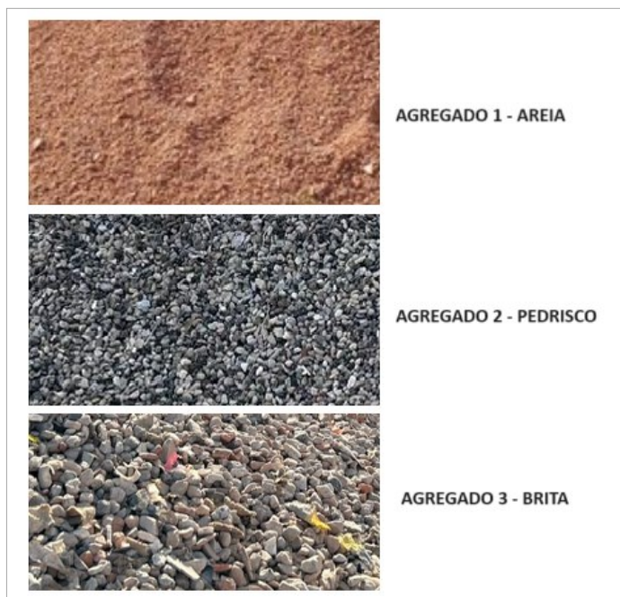
Figura 34 - Agregados reciclados após beneficiamento.
