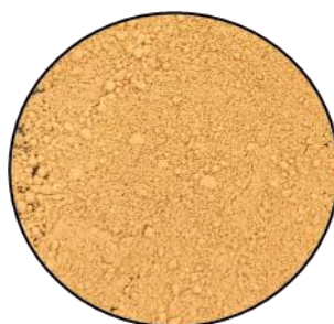
FIGURA 5 – Fotografia do hidróxido duplo lamelar (HDL) obtido a partir de resíduos ácido de decapagem (RAD).
