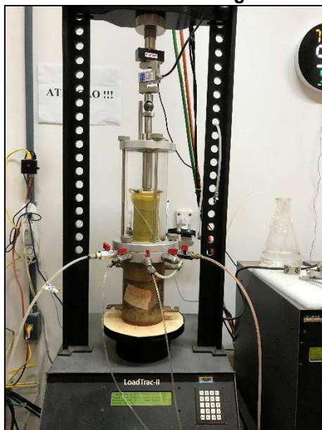
Figura 17 - Execução do ensaio triaxial
