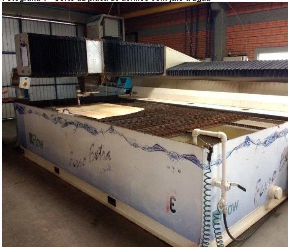
Fotografia 1 - Corte da placa de acrílico com jato d'água
