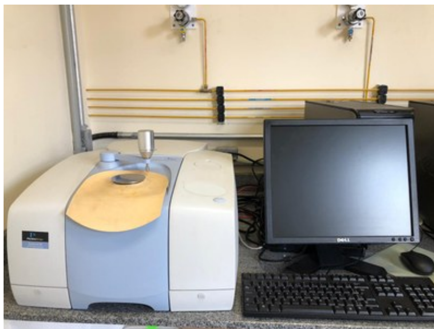
Figura 11 – Equipamento utilizado para as análises Análise por Espectroscopia no Infravermelho por Transformada de Fourier (FTIR)
