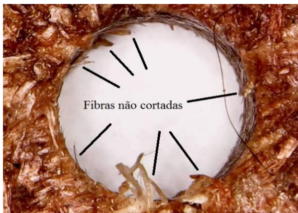
Figura 52 —Imagem da perfuração de entrada com a broca helicoidal utilizando V_c=56,5 m/min e avanço de 0,2 mm/rot
