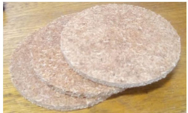
Figura 44 - Corpos de prova de absorção acústica. (a) Corte em fresadora CNC; (b) Corpos de prova prontos para análise
