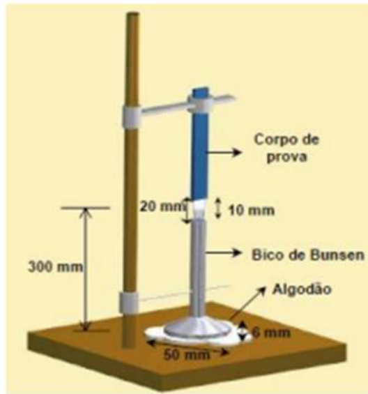
Figura 16 -Representação dos aparatos para o ensaio de flamabilidade vertical
