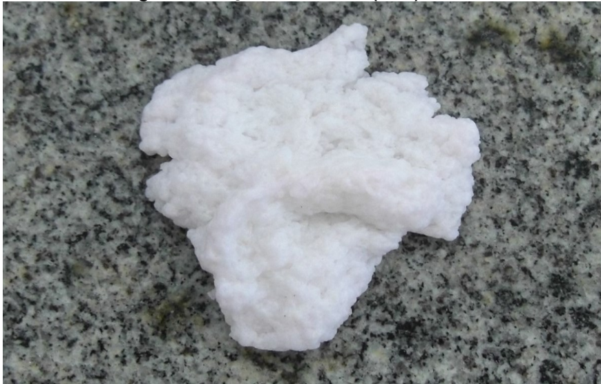
Figura 27 - Ação da acetona (60%) no EPS
