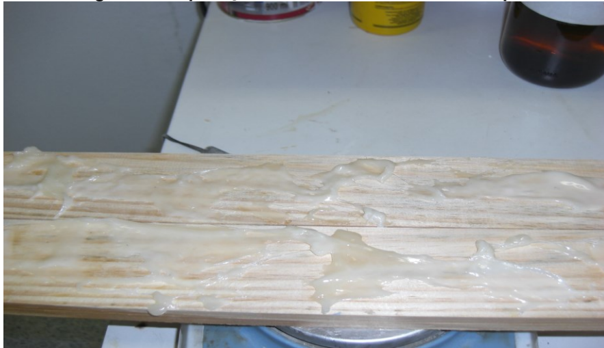
Figura 21 - Aplicação de adesivo nas faces das ripas
