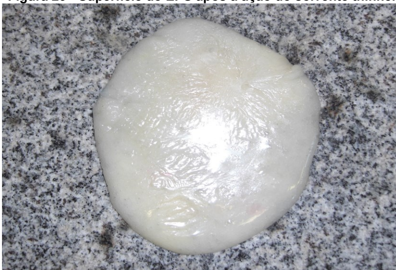
Figura 29 - Superfície do EPS após a ação do solvente thinner
