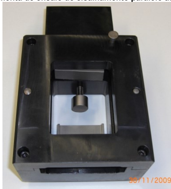
Figura 24 - Ferramenta de ensaio de cisalhamento paralelo às fibras na madeira
