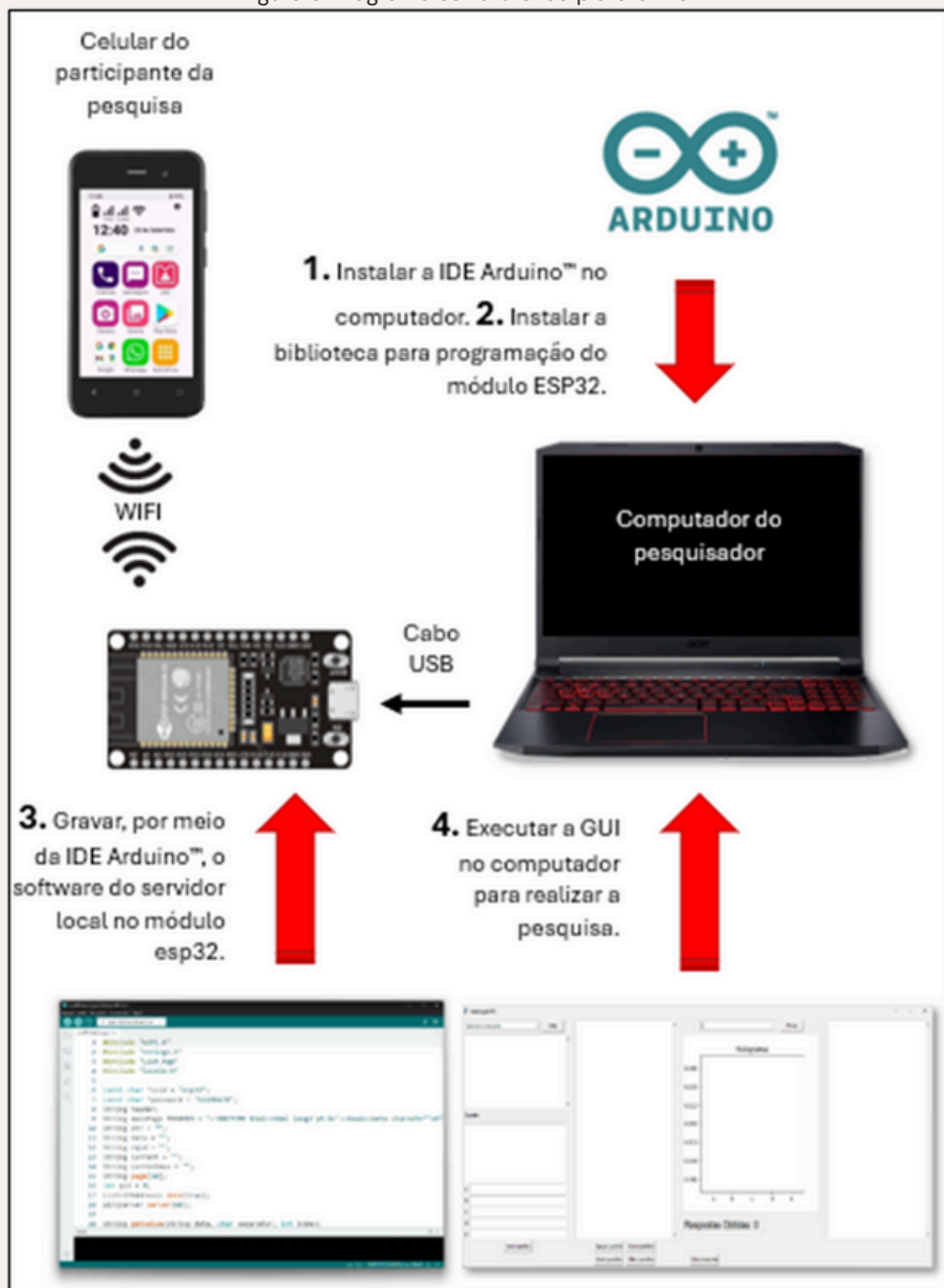
Figura 8: Diagrama estrutural da plataforma
