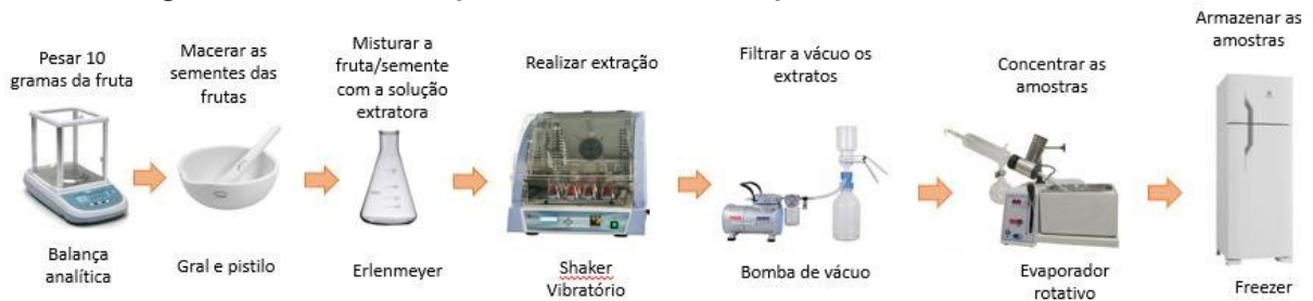
Figura 6 - Ilustração do procedimento adotado para a extração das amostras.
