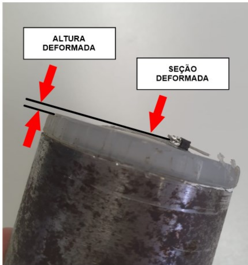
Fotografia 13 - Deformação do corpo de prova em Nylon.
