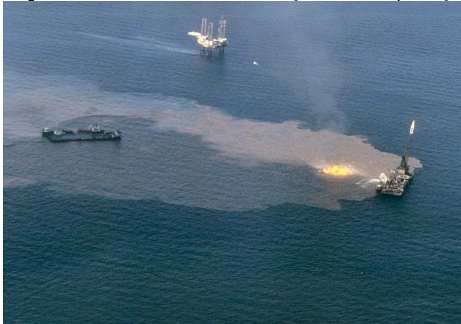
Fotografia 3 - Blowout devido à falta de circulação de fluido de perfuração.
