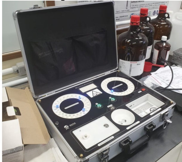
Fotografia 18 - Base de carregamento e acionamento dos sensores YuTech
