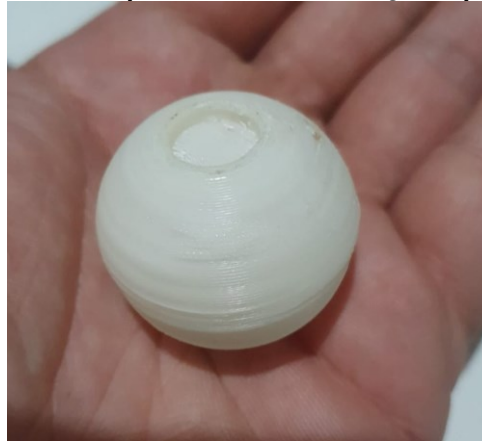
Fotografia 7 - Impressão 3D da carcaça do protótipo
