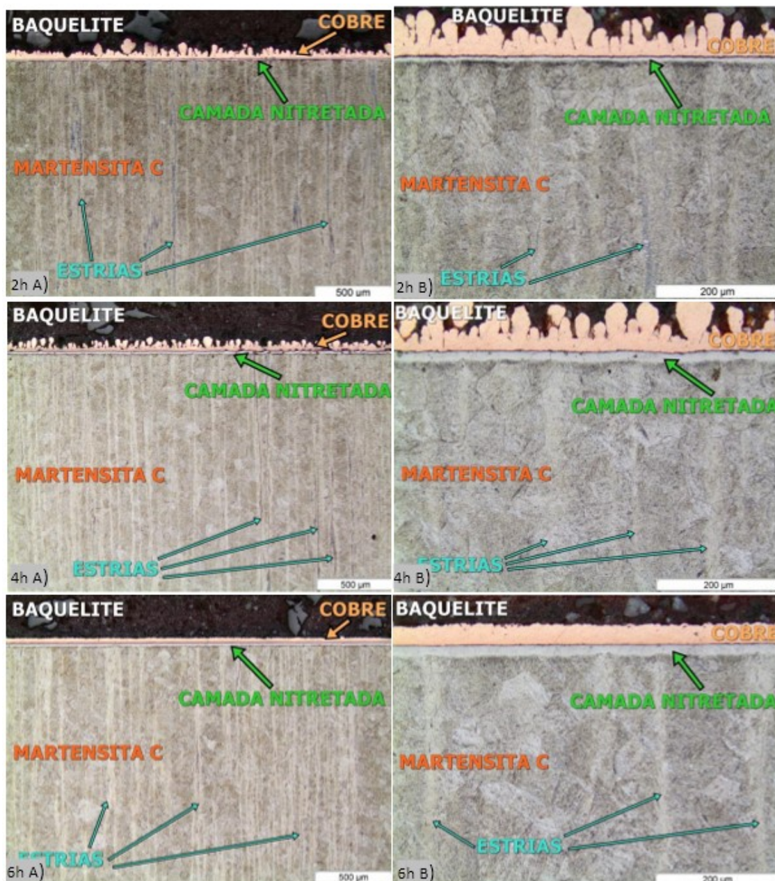
Figura 1 - Camadas AISI 420 Nitretadas por 2 horas 2h A) e 2h B), 4 horas 4h A) e 4h B) e 6 horas 6h A) e 6h B)
