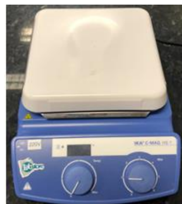
Figura 13 - Especificações Técnicas do Agitador Magnético com Placa de Aquecimento.
