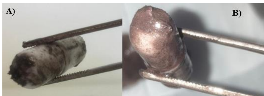
Figura 15 - Ocorrência de Magnetismo do Grafite durante Formulação das amostras com concentração de: A) 10 lb/bbl e B) 20 lb/bbl.
