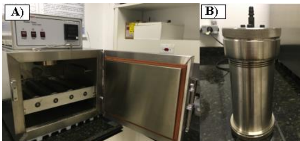
Figura 10 – A) Estufa Rotativa; B) Célula de envelhecimento de aço inoxidável.
