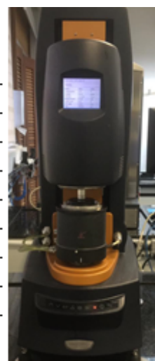
Figura 11 – Especificações Técnicas do Reômetro TA DHR-3 utilizado nos testes reológicos.
