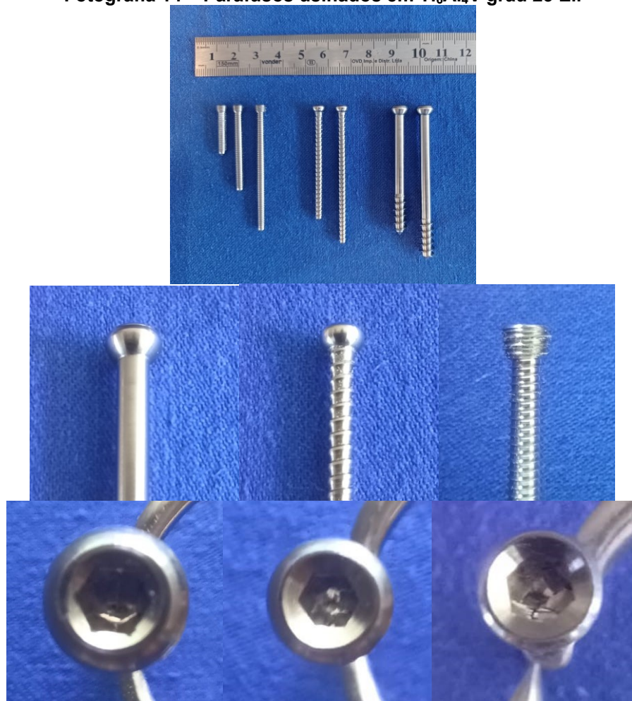
Fotografia 14 – Parafusos usinados em Ti_6Al_4V grau 23 Eli
