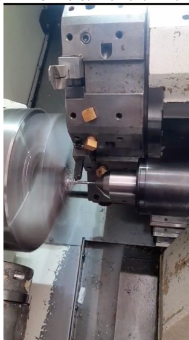
Fotografia 15 - Torno CNC Universal Yamazaki Mazak usinando parafuso
