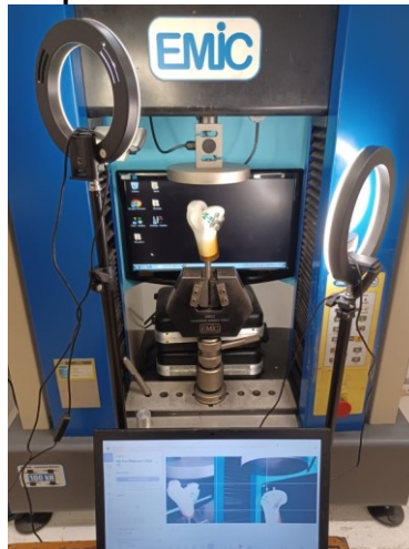
Fotografia 19 - Corpo de prova fixado ao equipamento de ensaio mecânico com posicionamento simulando o apoio do membro inferior durante descida de escada.
