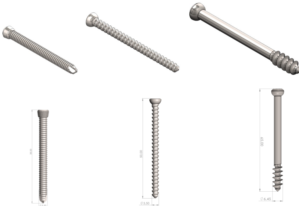
Figura 18 - Projeto do parafuso bloqueado 3,5 mm, parafusos convencionais 3,5 mm e parafuso 6,5 mm rosca parcial realizado com o software SolidWorks v19.0. Cotas em mm
