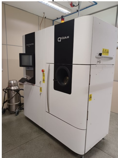
Fotografia 6 - Equipamento de MA com a tecnologia EBM localizado no CTI Renato Acher em Campinas - SP
