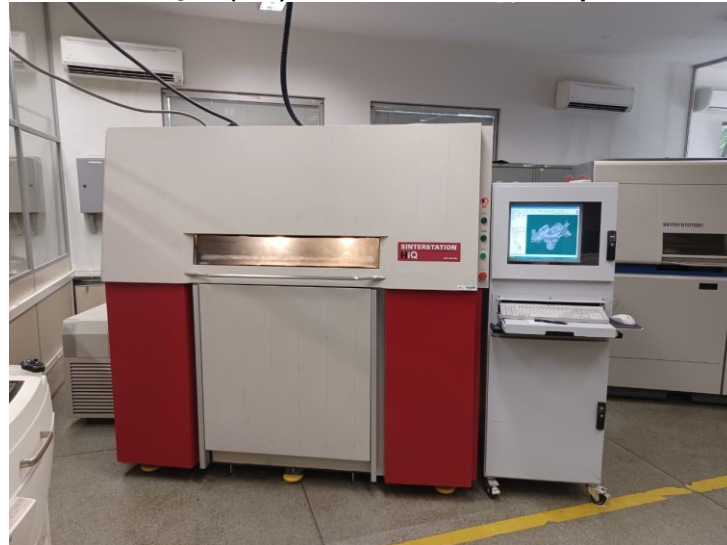
Fotografia 3 - Equipamento de MA com a tecnologia SLS localizado no Centro da Tecnologia da Informação (CTI) Renato Acher em Campinas - SP
