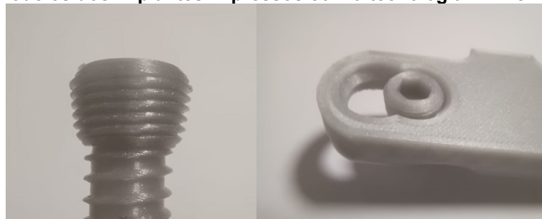
Fotografia 4 - Modelos dos implantes impressos com a tecnologia FDM em escala de 300%
