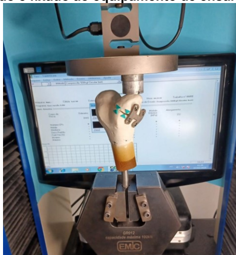
Fotografia 17 – Corpo de prova preparado com cilindro metálico e resina de poliéster posicionado e fixado ao equipamento de ensaio mecânico
