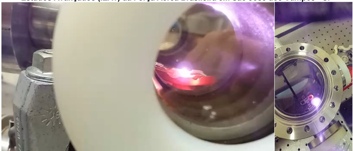
Fotografia 11 - Imagem interna do equipamento com câmara de vácuo no momento de varredura do feixe de laser localizado no laboratório da Divisão de fotônica do Instituto de Estudos Avançados (IEAv) da Força Aérea Brasileira em São José dos Campos - SP
