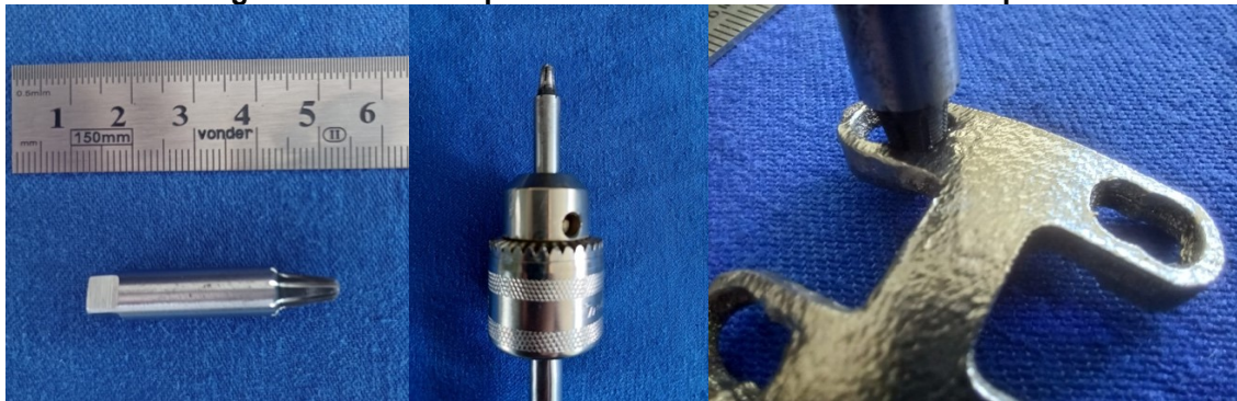
Fotografia 12 – Macho para abertura dos filetes da rosca da placa
