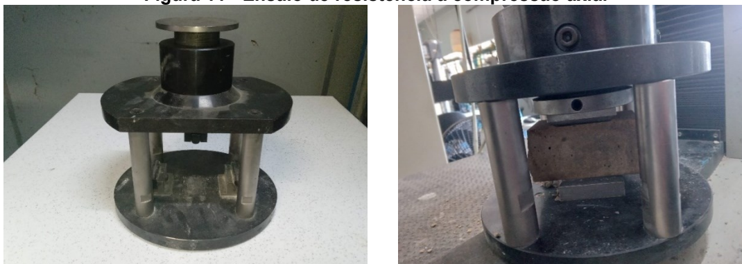
Figura 11 - Ensaio de resistência à compressão axial
