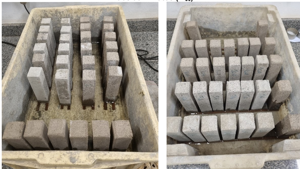
Figura 8 - Ensaio de absorção de água por capilaridade aos 10 minutos ( m_{10} ) e aos 90 minutos ( m_{90} )
