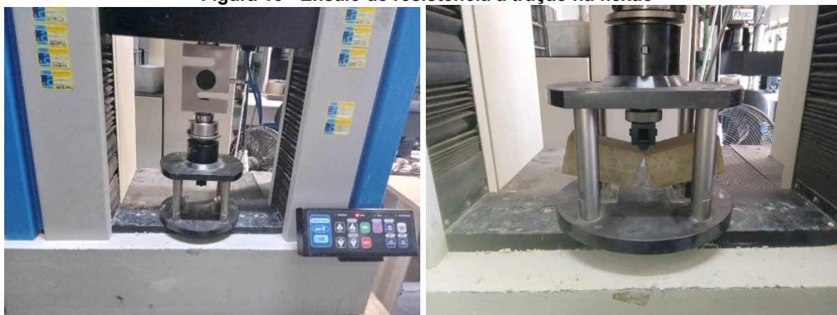
Figura 10 - Ensaio de resistência à tração na flexão
