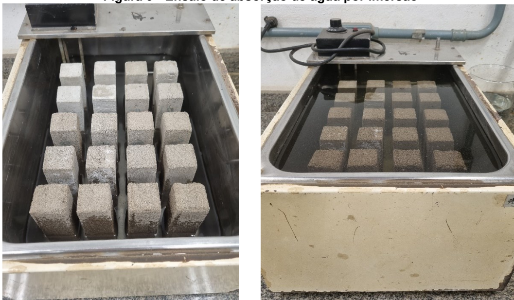
Figura 9 - Ensaio de absorção de água por imersão
