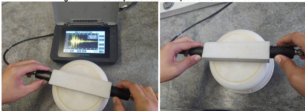
Figura 12 - Ensaios para a determinação do MOE dinâmico
