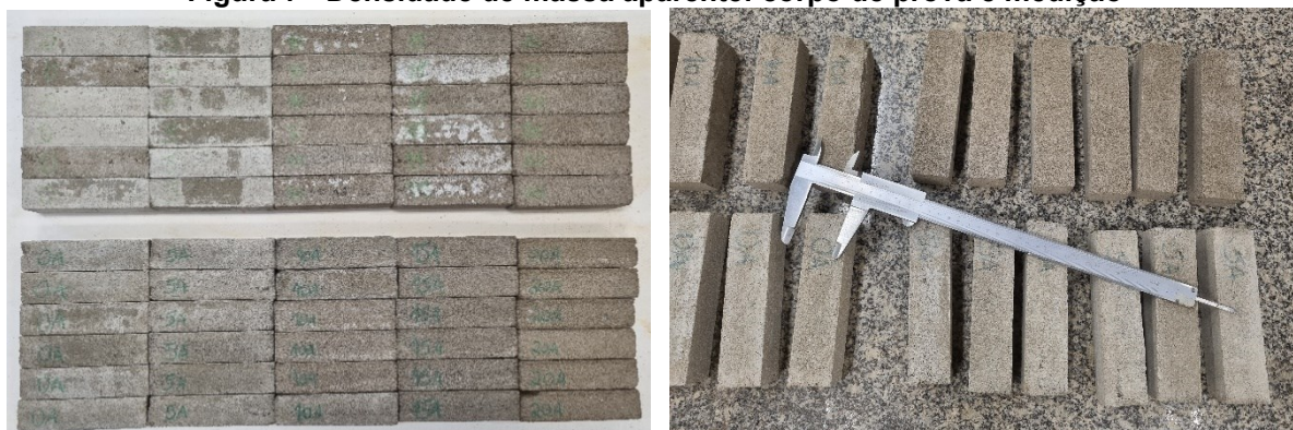
Figura 7 - Densidade de massa aparente: corpo de prova e medição
