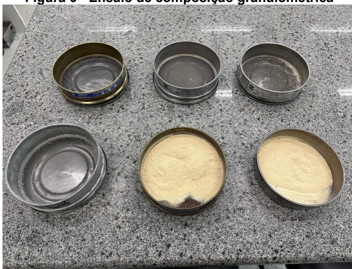
Figura 6 - Ensaio de composição granulométrica
