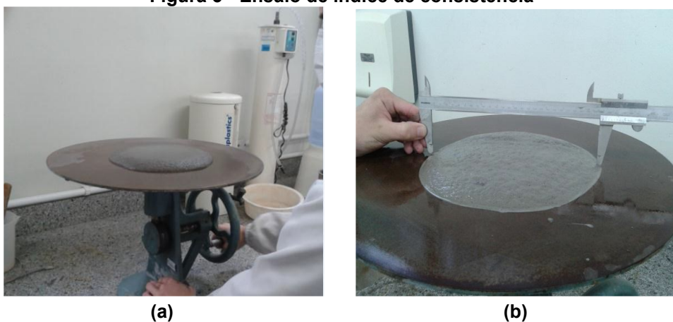
Legenda: mesa de queda (a) e índice de consistência (b). Fonte: Autor (2024)
