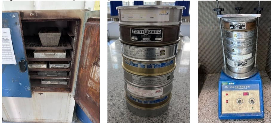
Figura 5 - Estufa e peneiras para ensaio de composição granulométrica
