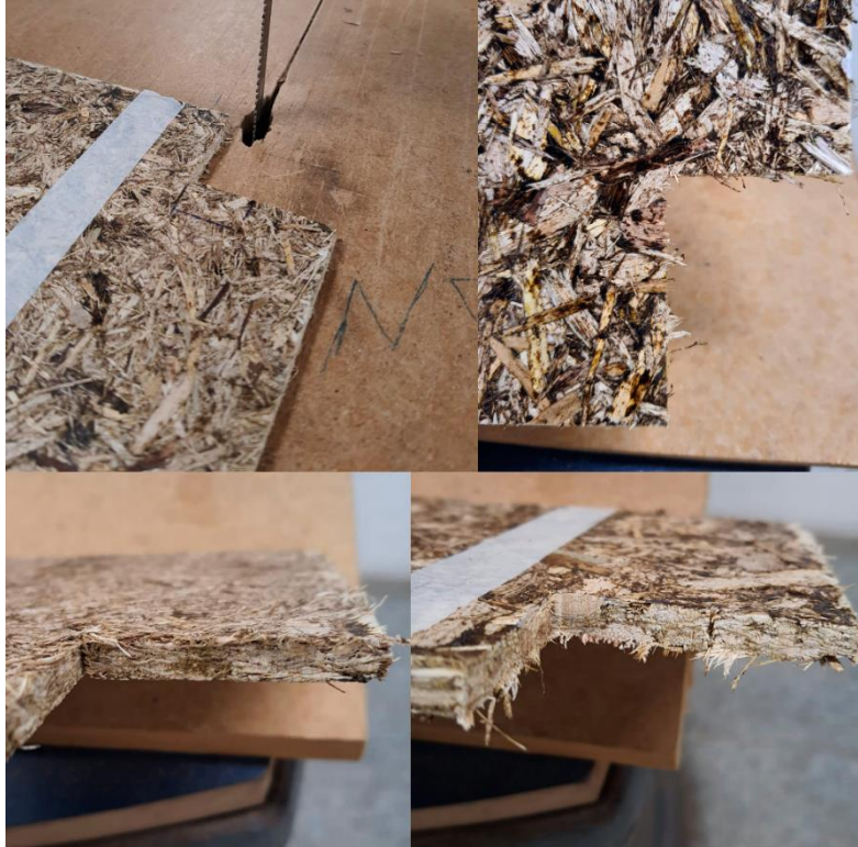
Figura 19 - Usinagem com serra fita Fonte: Acervo da autora, 2022.
