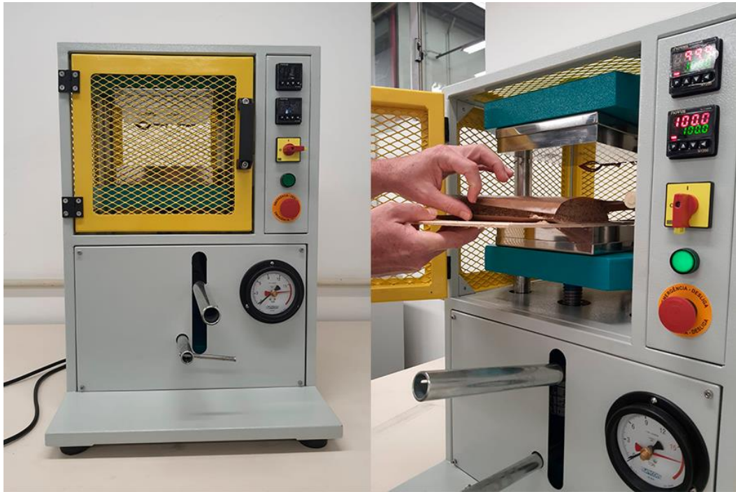
Figura 6 - Prensa hidráulica para esmagamento com aquecimento. Fonte: Acervo da autora, 2022.
