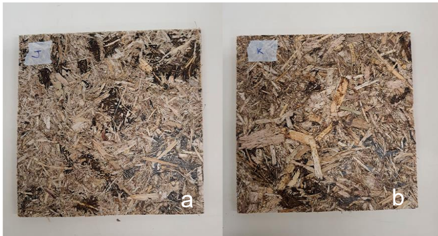
Figura 17 - (a) 90g de fibra média e 27g de resina; (b) 90g de fibra grossa e 18g de resina.
