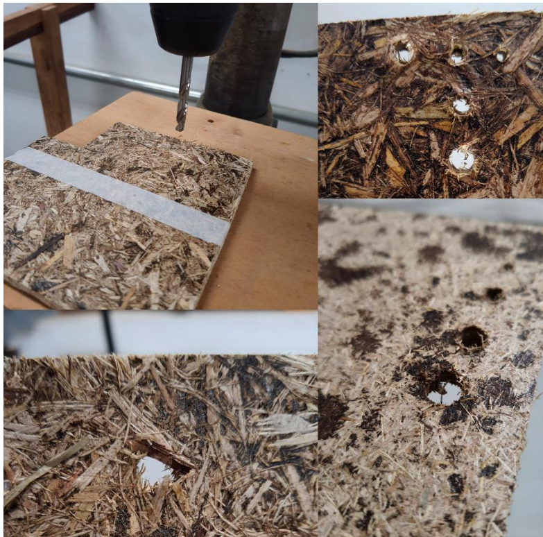
Figura 20 - Usinagem com furadeira Fonte: Acervo da autora, 2022.
