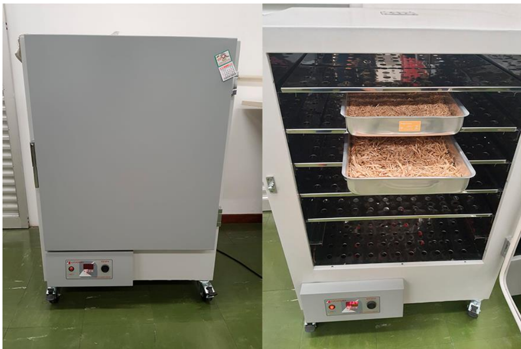
Figura 5 - Estufa de secagem e esterilização Fonte: Acervo da autora, 2022
