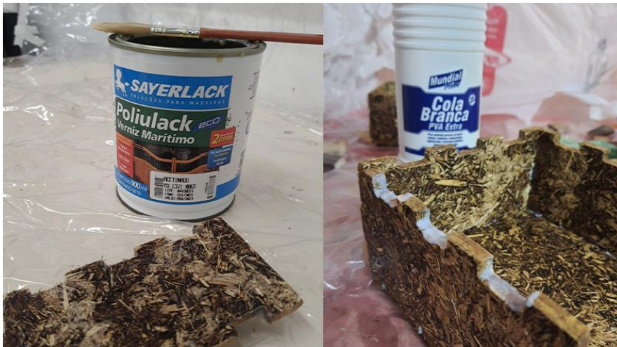
Figura 30 - Montagem e acabamento do protótipo Fonte: Acervo da autora, 2022
