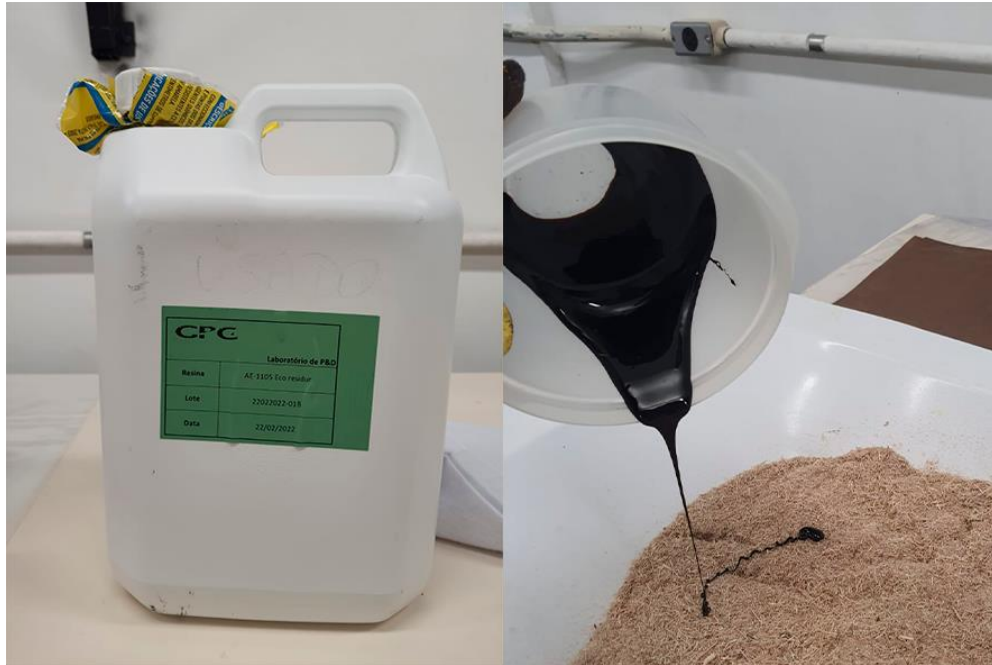
Figura 9 - Resina à base de Lignina Fonte: Acervo da autora, 2022.
