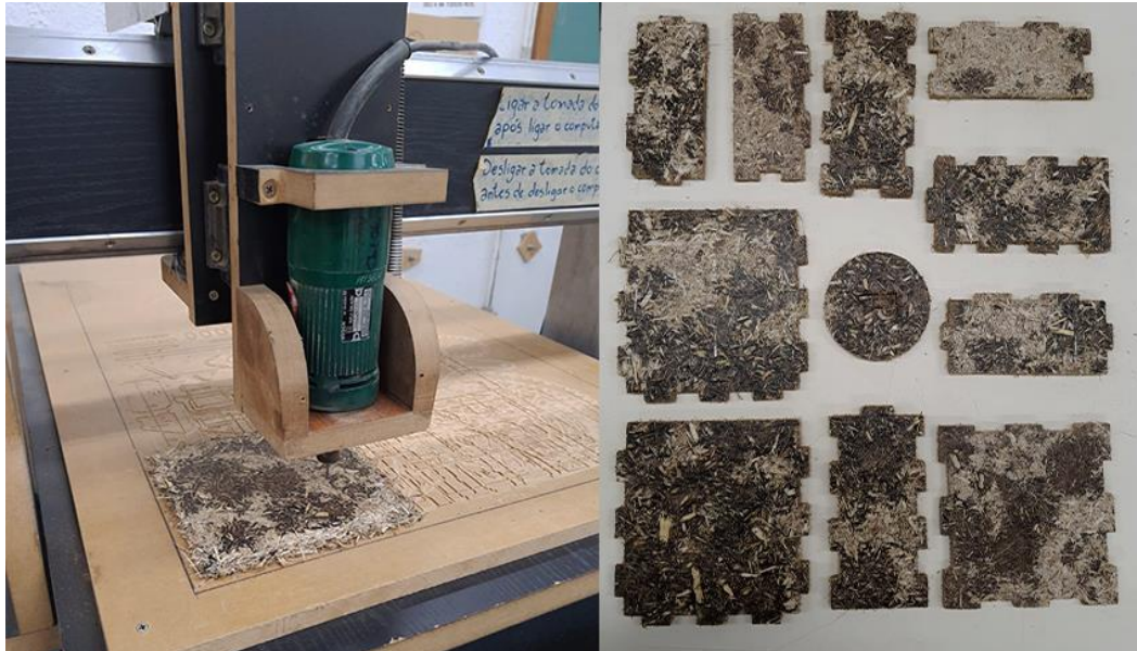
Figura 28 - Usinagem das peças para protótipo Fonte: Acervo da autora, 2022.
