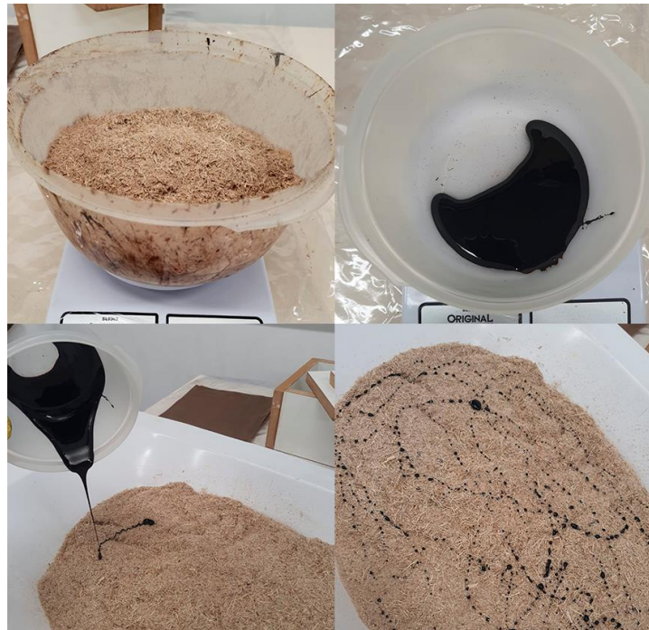
Figura 11 - Preparação das fibras Fonte: Acervo da autora, 2022.
