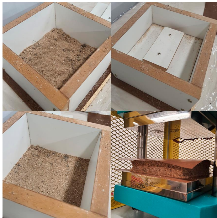
Figura 12 - Fibras conformadas para ir à prensa Fonte: Acervo da autora, 2022
