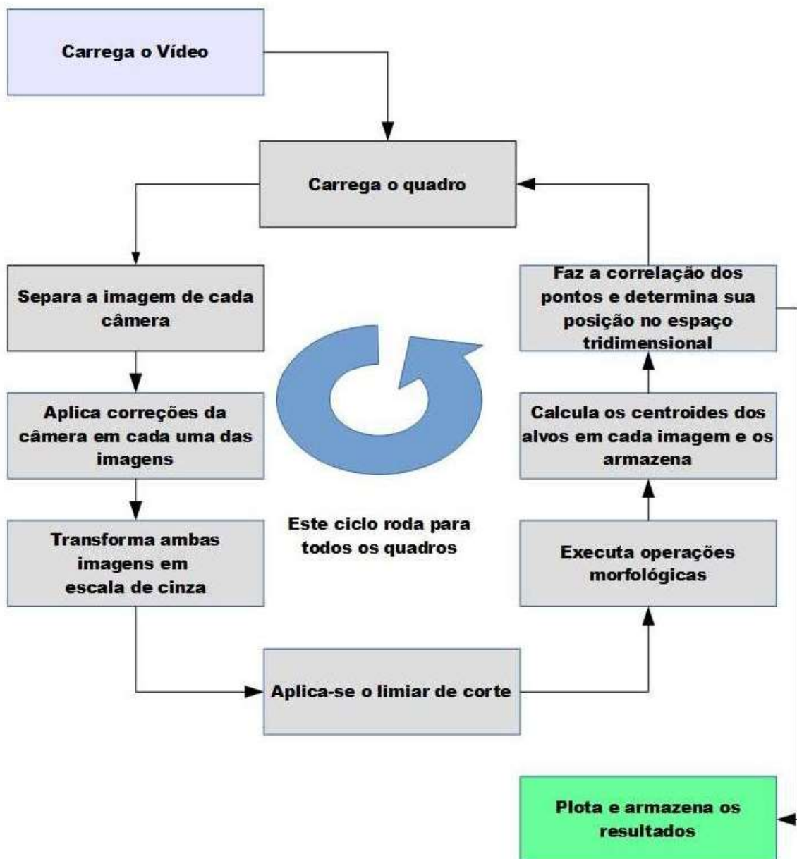
Figura 38 - Esquema do funcionamento da rotina computacional para reconhecimento de pontos em 3D
