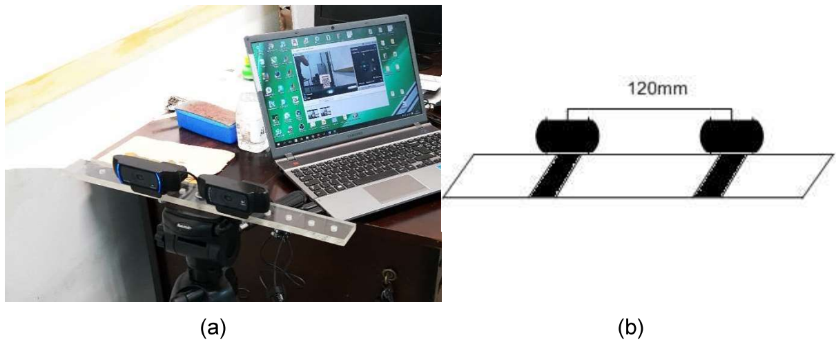
Figura 33 - Suporte e Câmeras para filmagem estérea. (a) Suporte devidamente montado. (b) Esquema do posicionamento das câmeras
