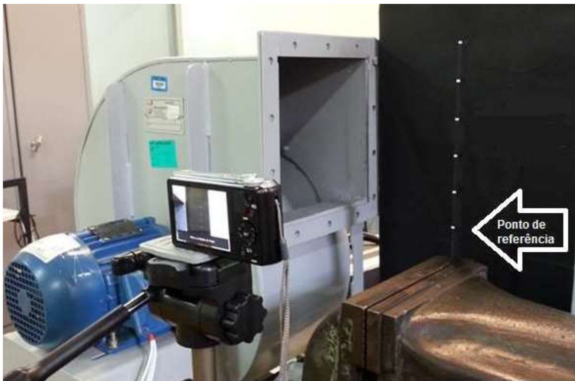
Figura 26 – Experimento de análise modal baseada apenas na resposta, utilizando o sensor câmera
