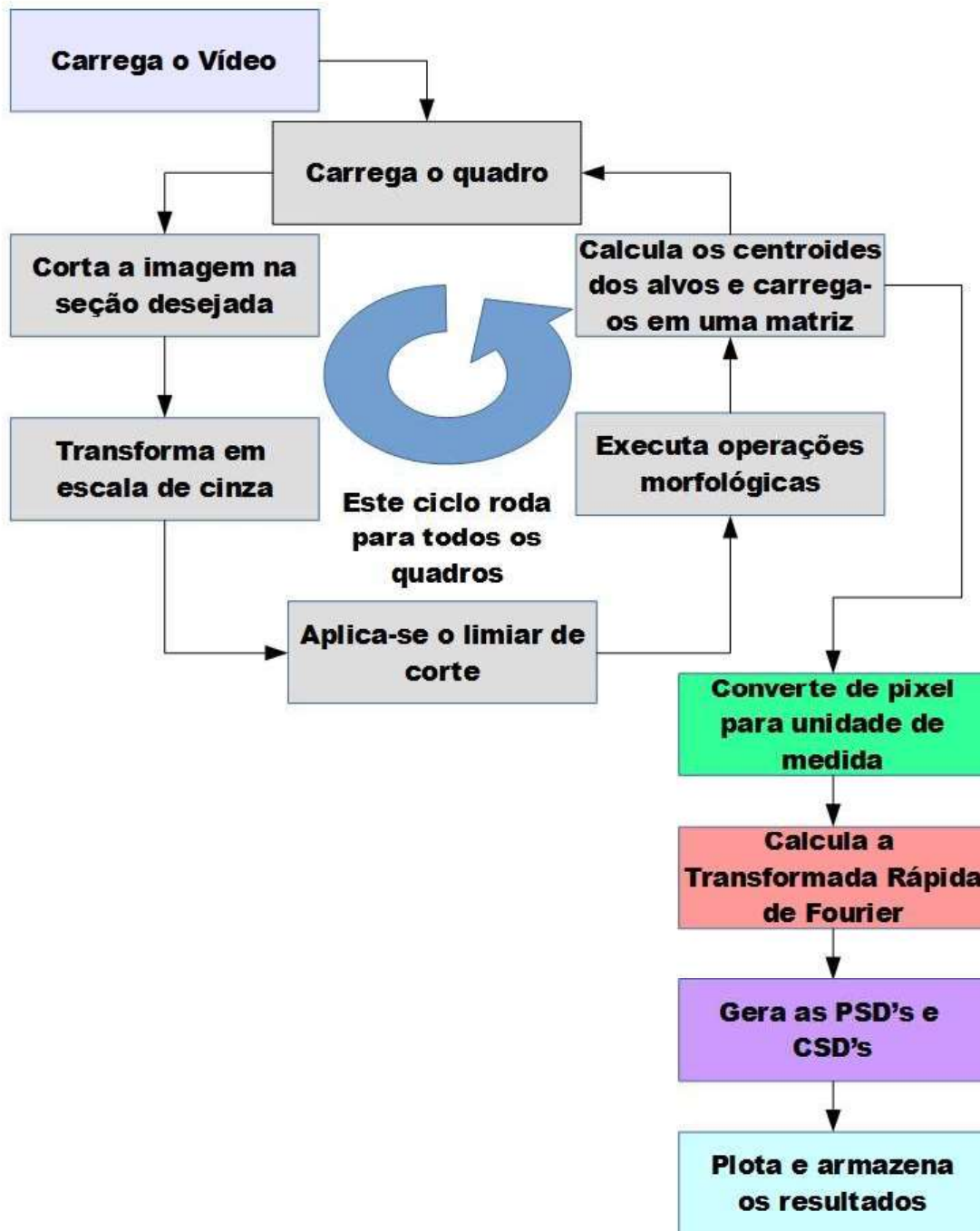
Figura 27 - Esquema do funcionamento da rotina computacional Fonte: Autoria própria
