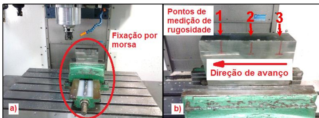
Figura 29 - a) Fixação do corpo de prova – b) Pontos de medição da rugosidade superficial
