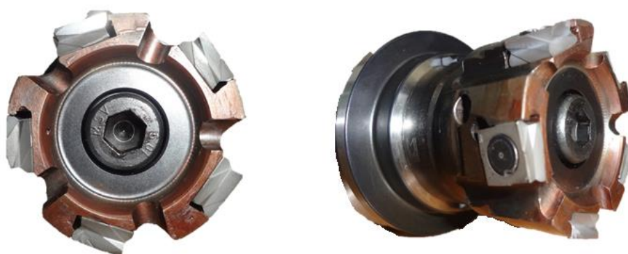
Figura 22 - Cabeçote de fresar 50A05RP90SP12CUFP Fonte: Autoria própria.
