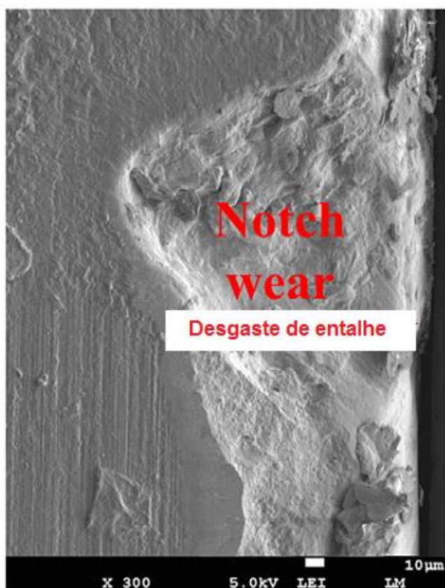
Figura 10 – Desgaste de entalhe Fonte: Zhuang et al. (2014).
