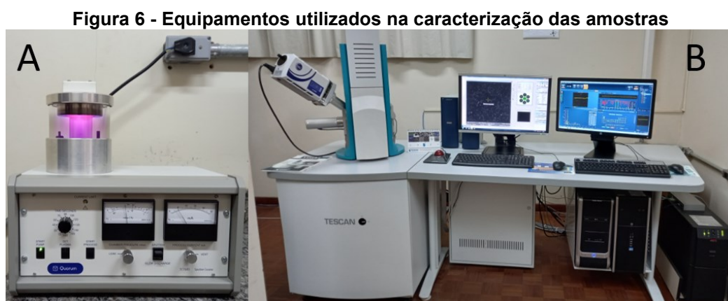
Nota: Metalizador (a), MEV acoplado ao EDS (B) Fonte: UTFPR (2023).
