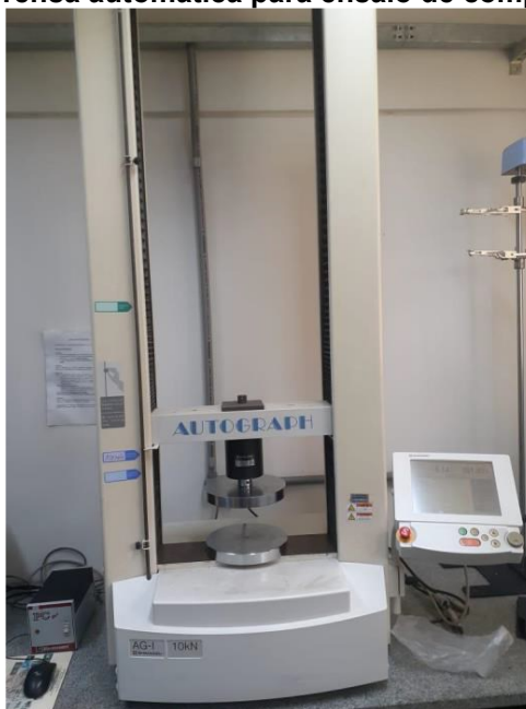
Fotografia 8 - Prensa automática para ensaio de compressão simples
