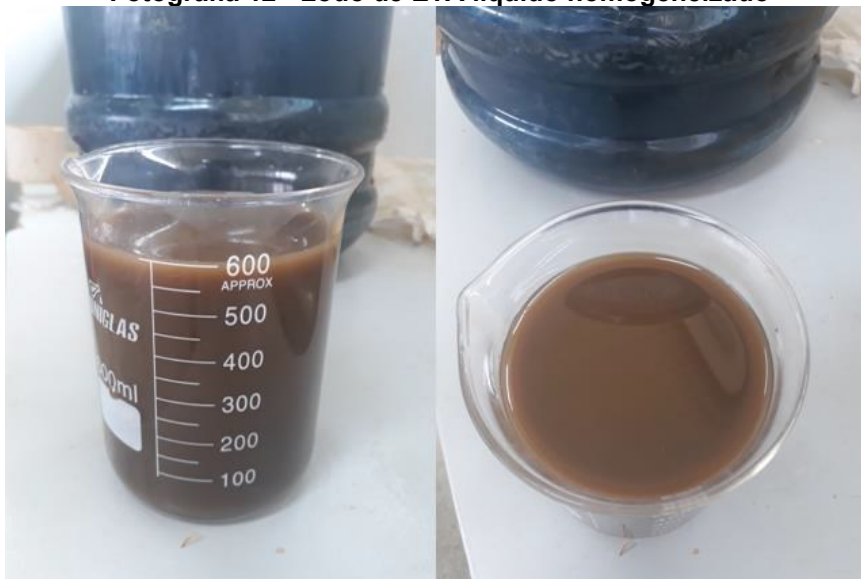
Fotografia 12 - Lodo de ETA líquido homogeneizado
