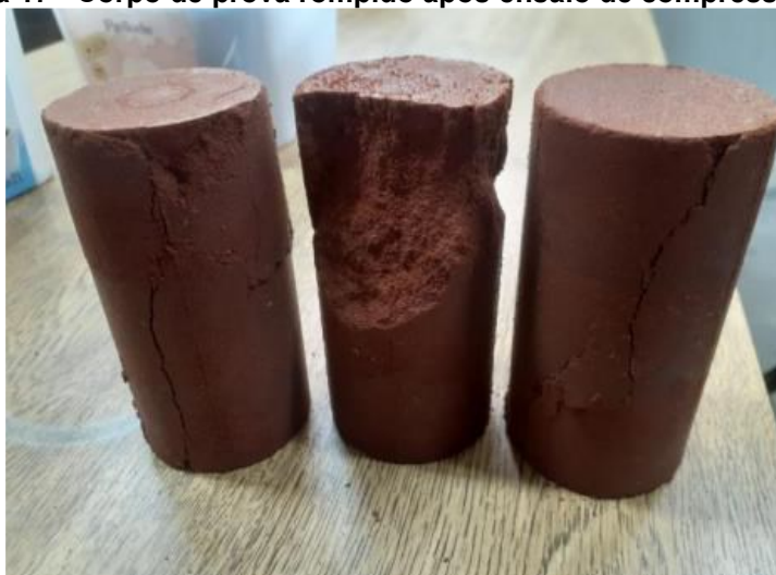
Fotografia 17 - Corpo de prova rompido após ensaio de compressão simples
