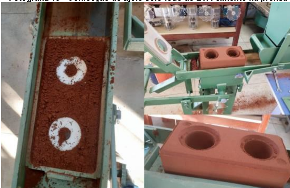
Fotografia 19 - Confeção de tijolo solo-lodo de ETA-cimento na prensa
