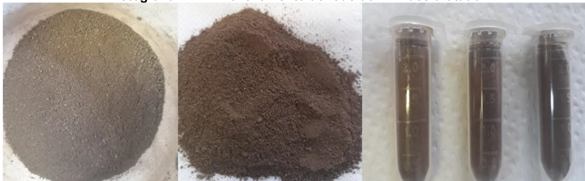
Fotografia 14 - Armazenamento do lodo de ETA desidratado
