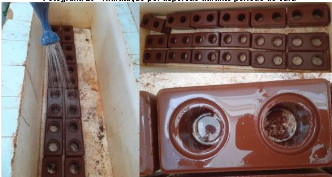
Fotografia 20 - Hidratação por aspensão durante período de cura
