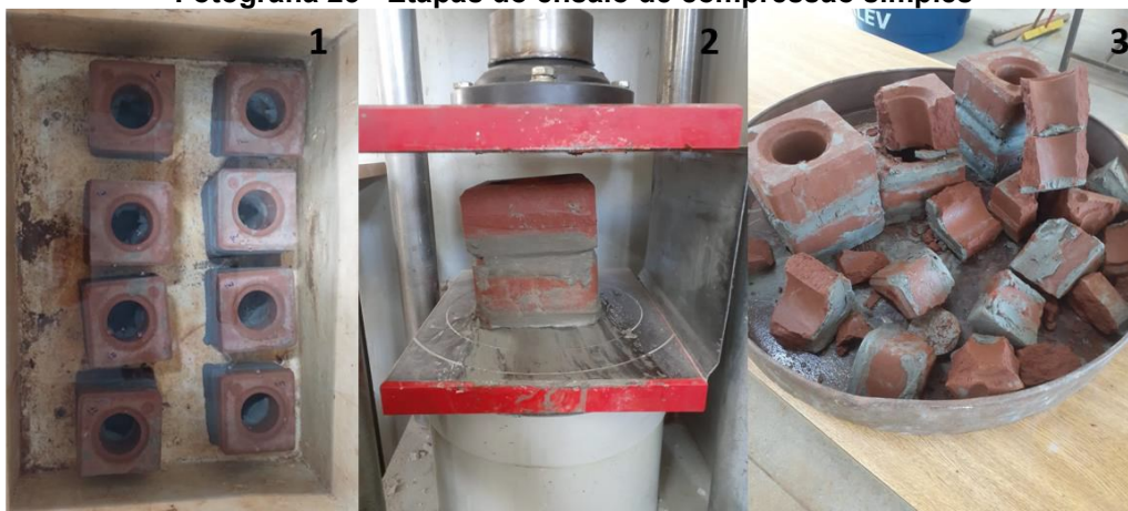
Fotografia 23 - Etapas do ensaio de compressão simples
