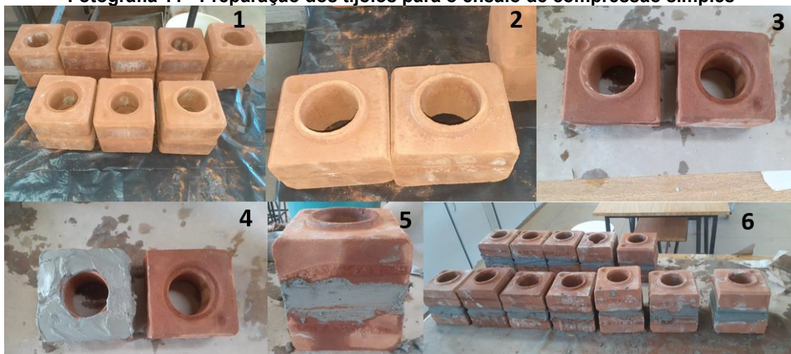
Fotografia 11 - Preparação dos tijolos para o ensaio de compressão simples
