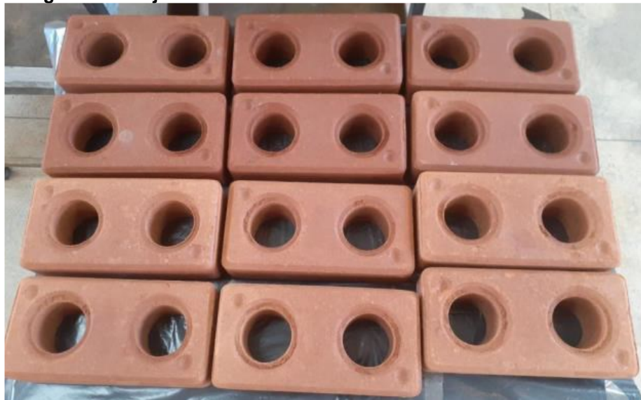
Fotografia 22 - Tijolos de solo-lodo de ETA-cimento com 28 dias de idade
