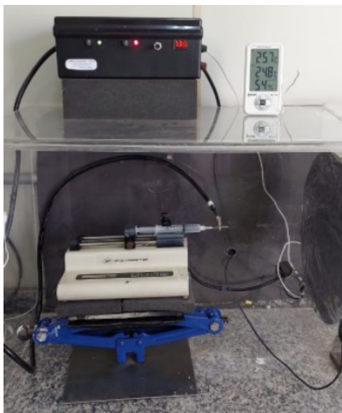
Figura 9 - Sistema de eletrofiação do laboratório L008 da UTFPR-Londrina
