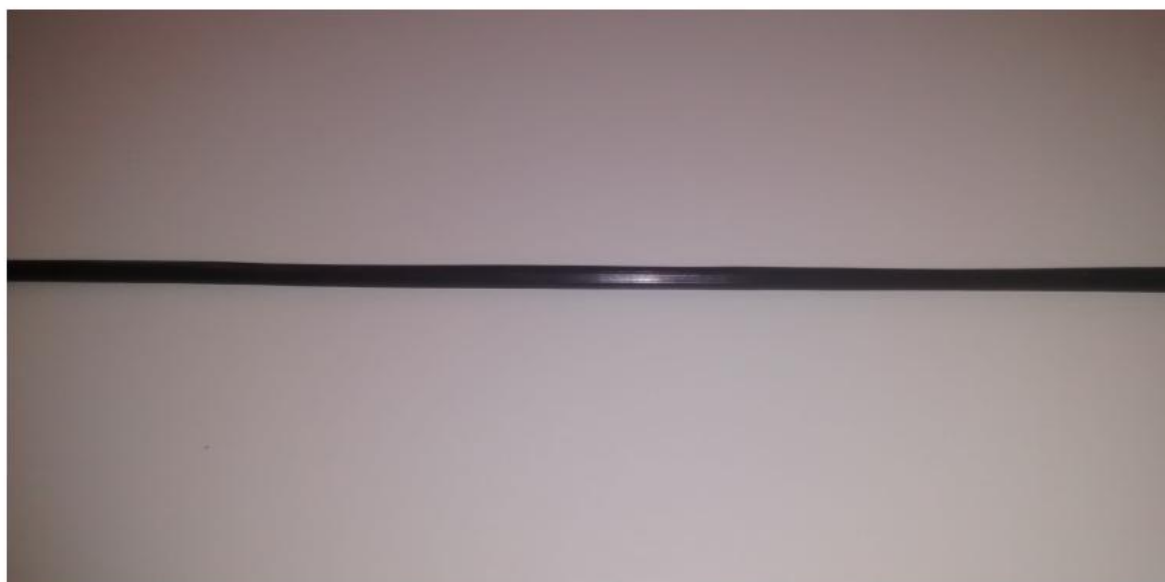
Figura 6: Filamento produzido com material com baixa taxa de umidade.
