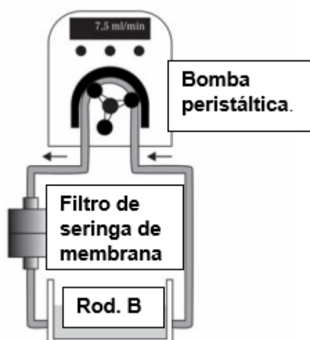
Figura 7. Sistema de mecanismo de filtração para solução de rodamina B.
