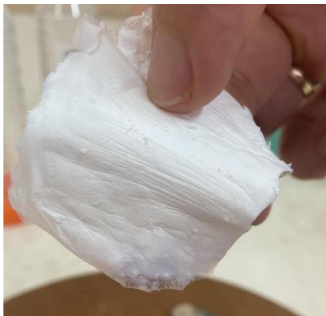
Figura 9. Filme de náilon obtido por meio da eletrofiação
