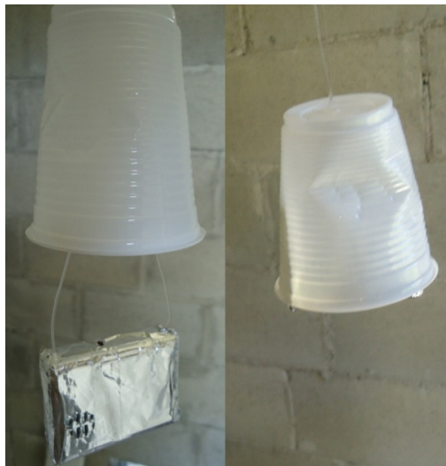
FIGURA 33- HOBO ® embrulhado com papel alumínio e sendo colocado em um copo de plástico, e HOBO ® já dentro do copo de plástico
