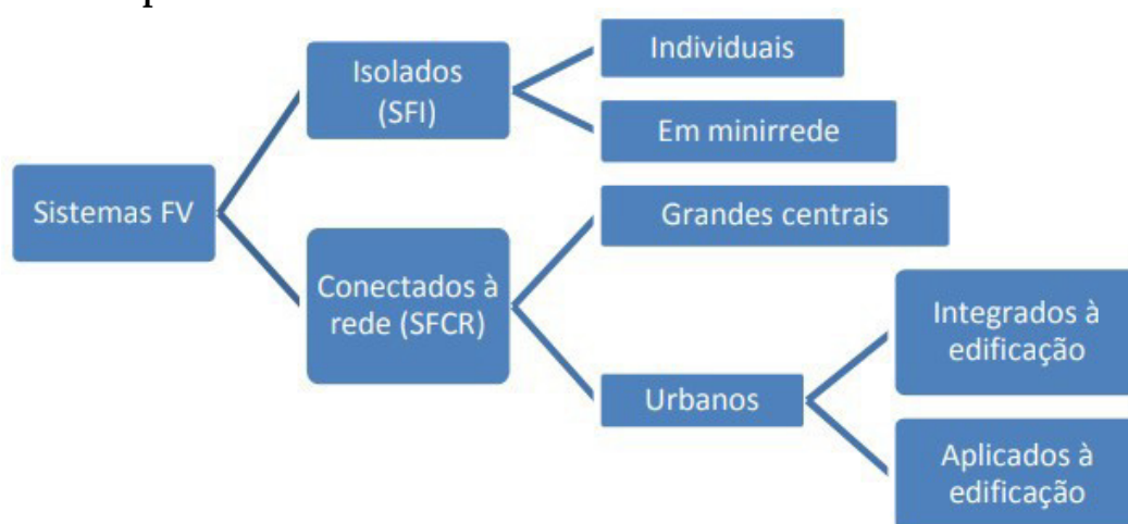
Figura 14 – Tipos de sistemas fotovoltaicos
