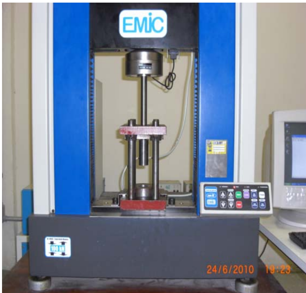
Figura 35 - Foto da Montagem do Equipamento para Ensaio de Puncionamento
