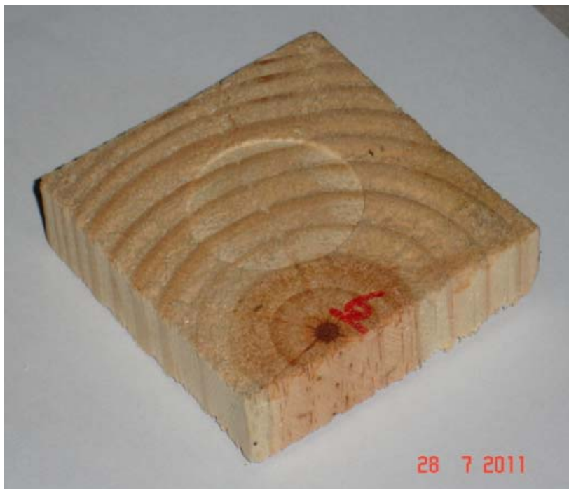
Figura 31- Foto do Corpo de Prova para o Método do Puncionamento proposto pela dissertação
