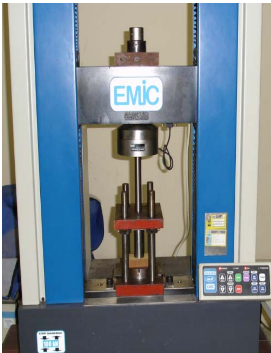
Figura 32 - Arranjo do Ensaio por Puncionamento
