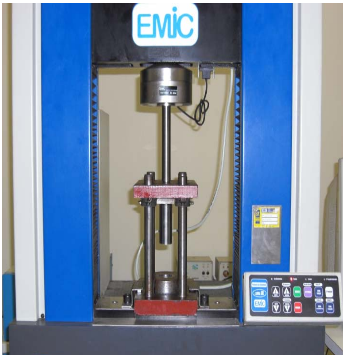
Figura 24 - Ferramenta de Ensaio de Cisalhamento Paralelo às Fibras da Madeira Induzidos por Puncionamento, Montado na Máquina Universal de Ensaios
