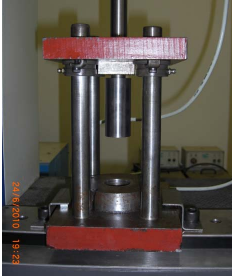
Figura 23 - Plataforma Mecânica para Montagem de Ferramentas com o Conjunto de Macho e Fêmea do punção
