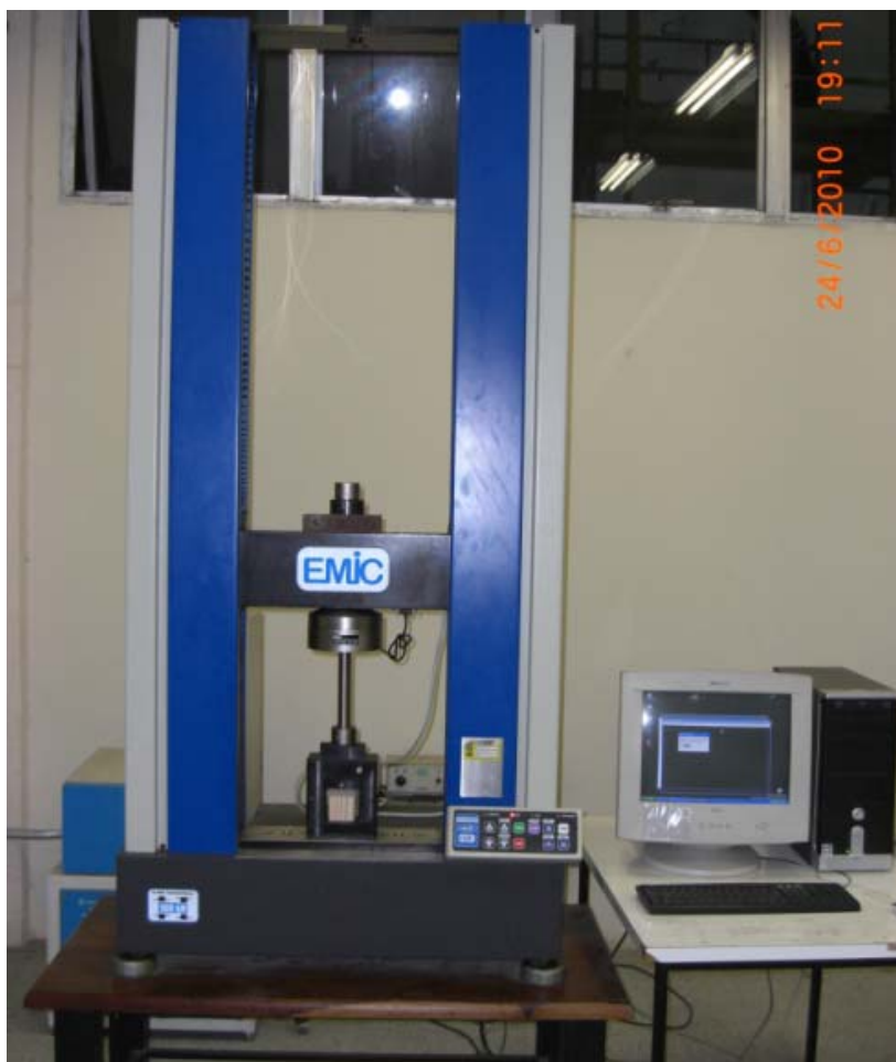
Figura 33 - Foto da Máquina Universal de Ensaio, EMIC, Modelo DL 10.000
