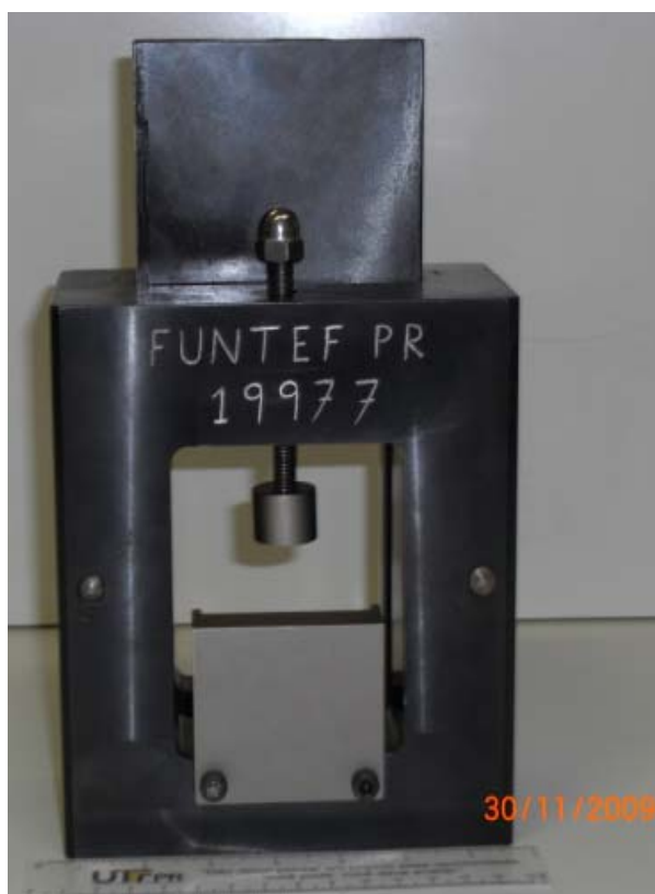
Figura 34 - Ferramenta para o Ensaio de Cisalhamento Normatizado – NBR7190/97
