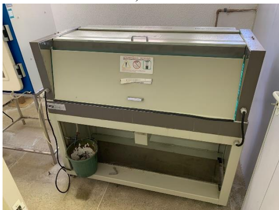
Figura 10A - Câmara de envelhecimento.
