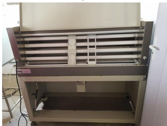
Figura 10B - Câmara de envelhecimento equipada com lâmpadas fluorescentes UV-B
