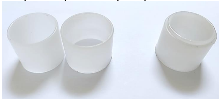
Fotografia 1 - Suporte para exposição das amostras. A esquerda o suporte desmontado e a direita o suporte com plástico filme pronto para receber as amostras
