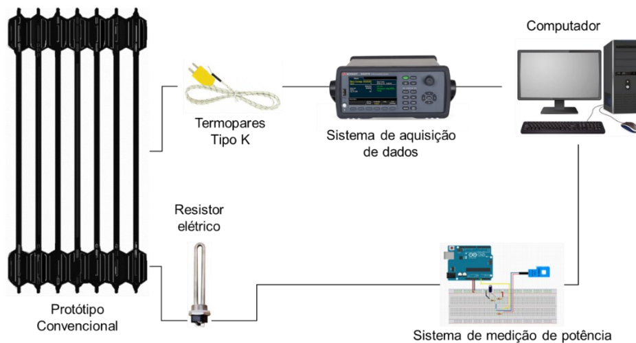
Figura 21 - Diagrama esquemático do aparato experimental: aquecedor comercial
