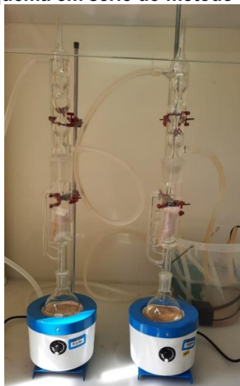
Fotografia 1: Esquema em série do método de soxhlet.
