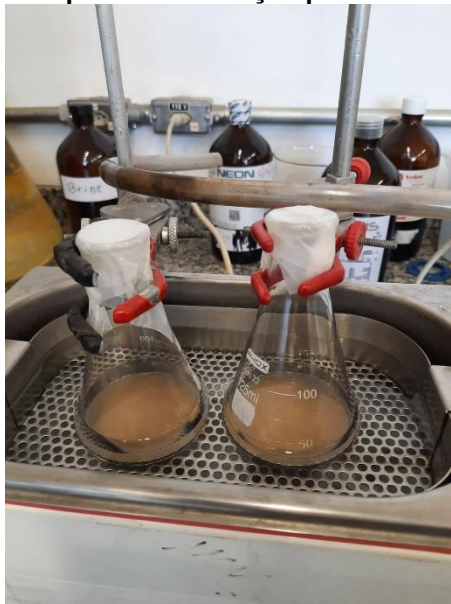
Fotografia 2: Esquema de extração por banho ultrassônico.
