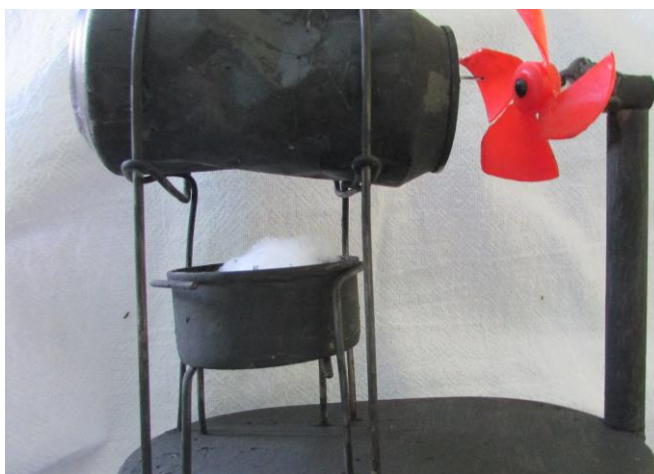
Figura 9: Mini usina elétrica construída com materiais alternativos.
