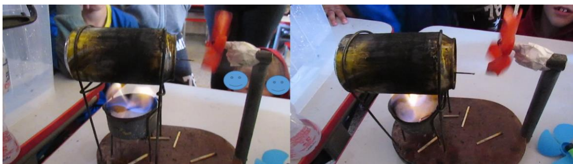
Figura 11: Demonstração da mini usina termoeétrica
