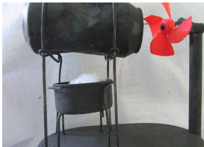
Figura 9: Mini usina elétrica construída com materiais alternativos.
