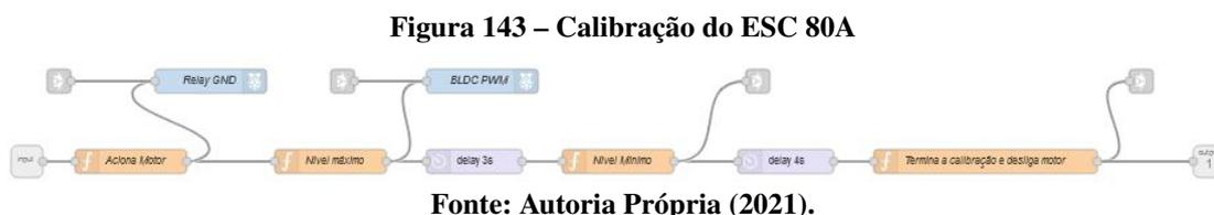
Com o ESC devidamente calibrado, o fluxo segue para o nó "Direciona Teste", no qual é feita a extração do modo de teste escolhido pelo usuário e o teste é realizado. Em caso de *Open Loop*, o usuário tem o controle do motor por meio de um botão deslizante, sem qualquer intervenção do software. Esse sinal é enviado diretamente ao ESC. Para casos de Modo Rotina, o usuário escolhe qual o modelo de rotina ele deseja. A bancada possui os seguintes modelos:
