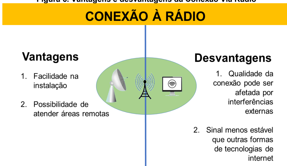
Figura 6. Vantagens e desvantagens da Conexão Via Rádio
