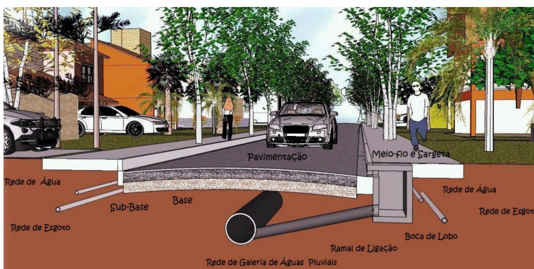
Figura 3 - Representação de um sistema de microdrenagem
