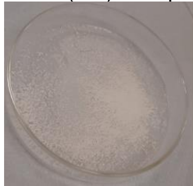
Figura 8: Nanotubos de titanato (NtsTi) obtidos pelo método hidrotérmico.
