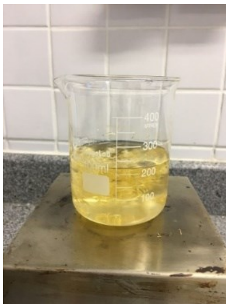
FIGURA 6 - TRATAMENTO ALCALINO DA FIBRA DE BUCHA VEGETAL COM NaOH PELO MÉTODO 2
