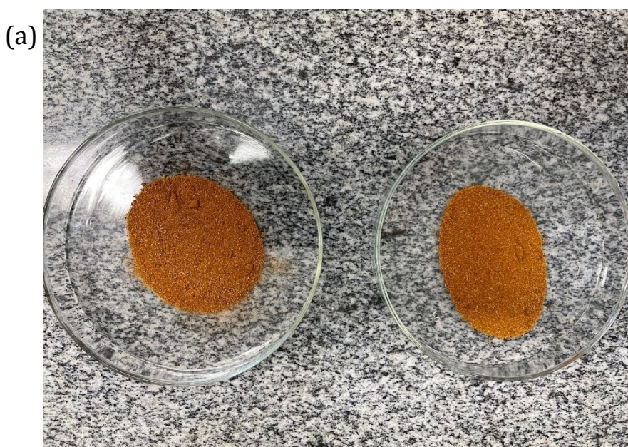
FIGURA 27 - COMPÓSITO SINTETIZADO A PARTIR DA BUCHA VEGETAL EM PÓ (A) E A PARTIR DA BUCHA EM FIBRA (B)
