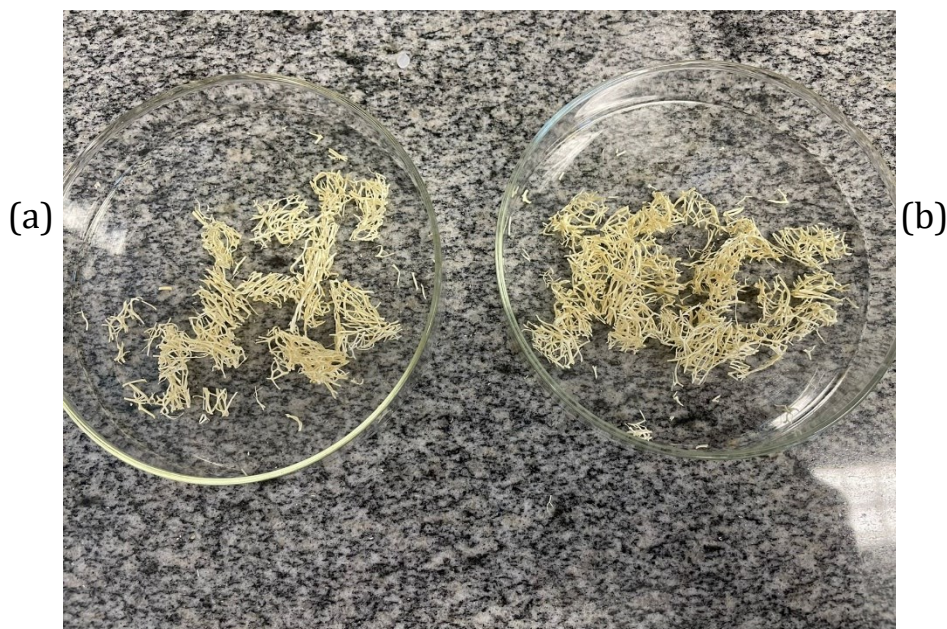
FIGURA 13 - BUCHA VEGETAL EM FIBRA APÓS O TRATAMENTO ALCALINO 1 (A) E 2 (B)
