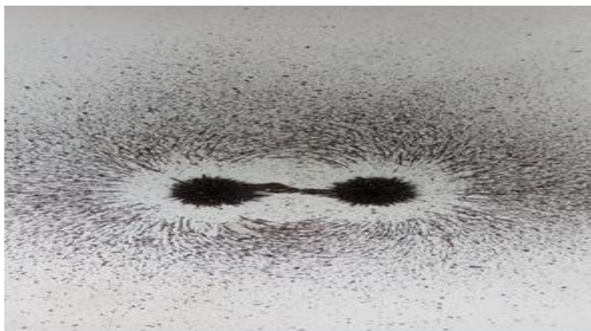
Figura 6: Linhas de indução de atração formada por dois ímãs de polos diferentes [Fonte: autoria própria].
