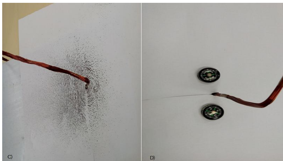
Figura 15: (C) Bobina colocada em um suporte de PVC, com bússolas próximas; (D) Linhas de indução de campo magnético gerado por passagem da corrente elétrica, e bússola indicando a direção o sentido das linhas de campo magnéticas geradas nas proximidades do fio [Fonte: autoria própria].
