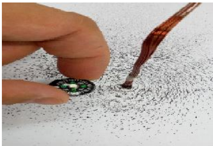
Figura 7: Foto de um condutor metálico percorrido por uma corrente elétrica, realizado durante aplicação experimentos [Fonte: autoria própria].
