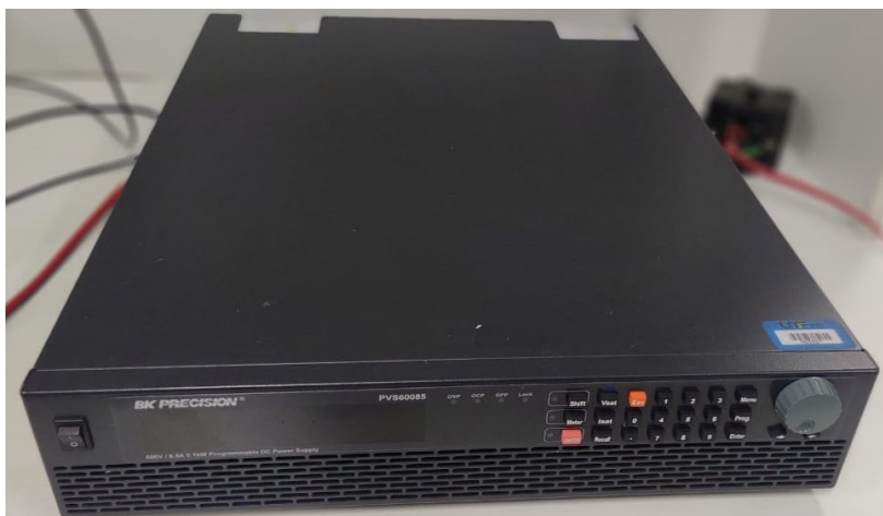
Figura 124 – Fonte simuladora de arranjo fotovoltaico.
