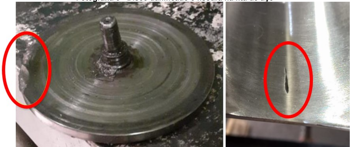
Fotografia 3 - Disco danificado e fissura na fita de aço
