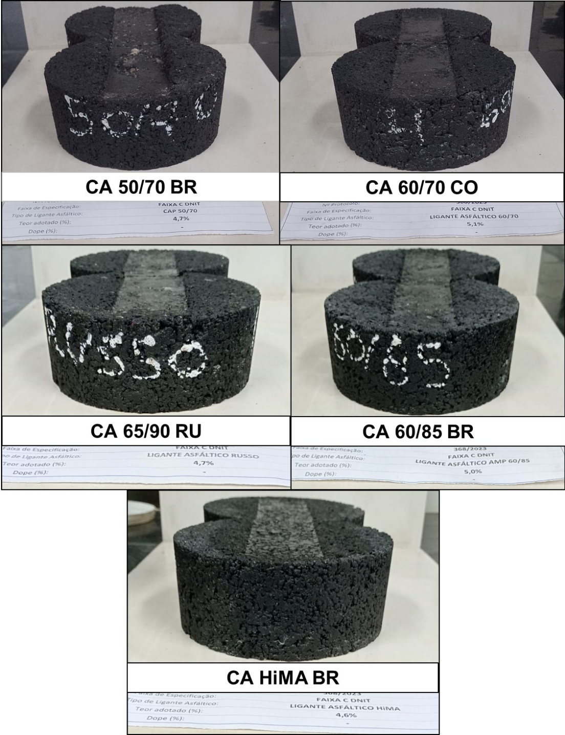
Figura 26 – Fotografias dos corpos de prova ensaiados no simulador de tráfego Hamburgo
