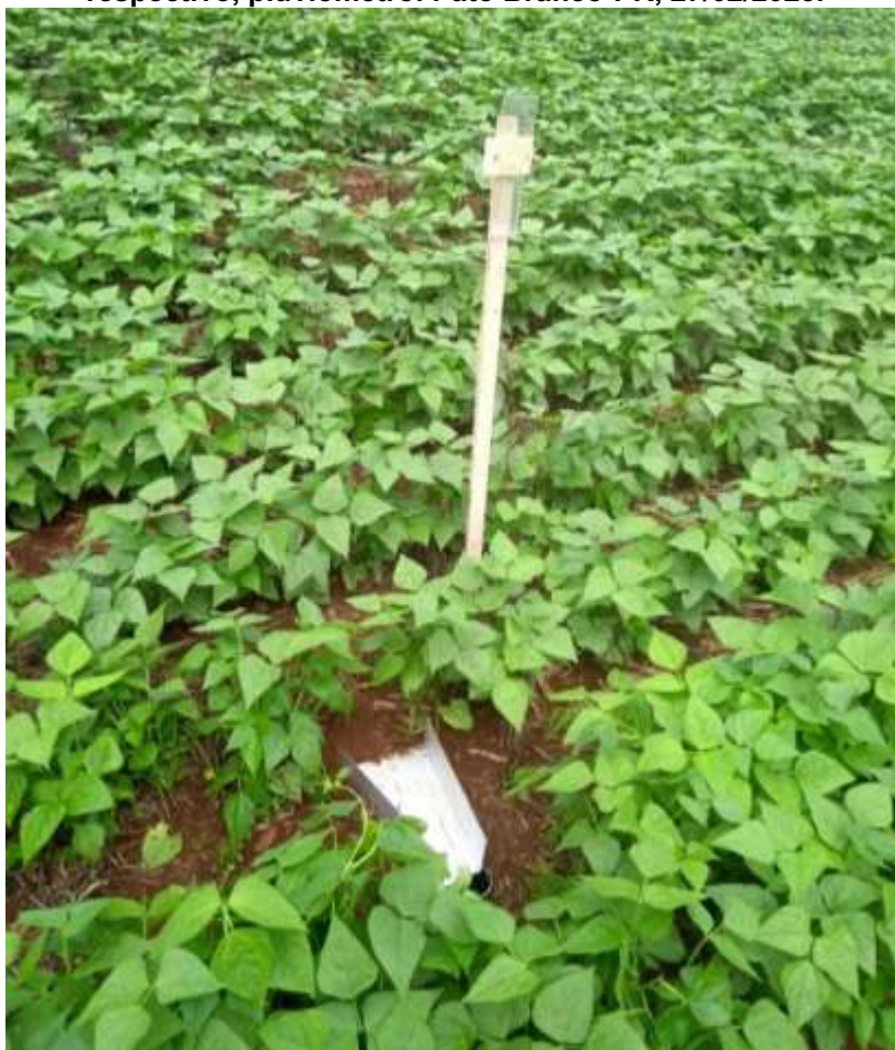
Figura 9 – Sistema de coleta e armazenamento de sedimento instalado no campo com seu, respectivo, pluviômetro. Pato Branco-PR, 27/02/2023.
