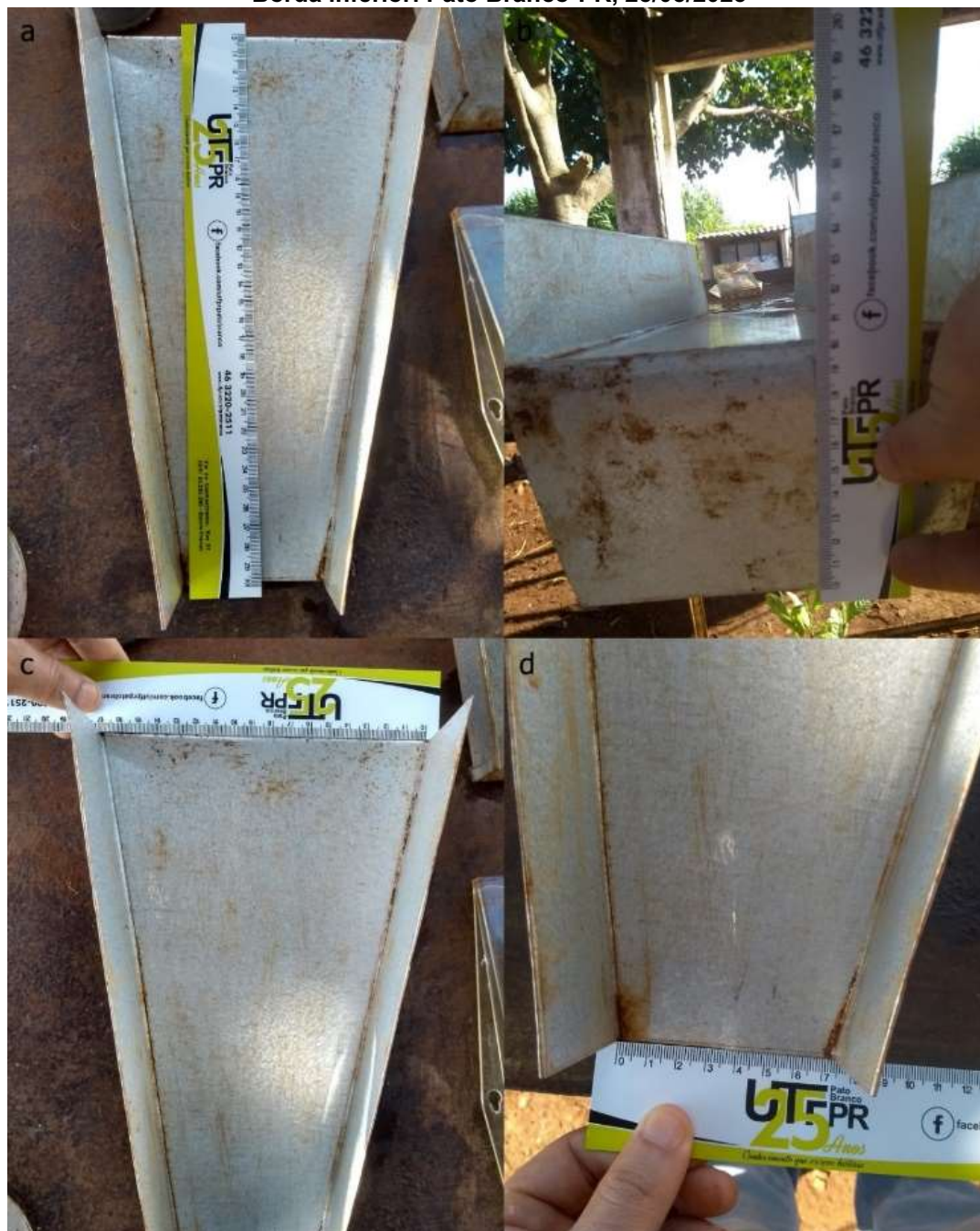
Figura 6 – Dimensões do coletor: (a) Comprimento; (b) Profundidade; (c) Borda superior; e (d) Borda inferior. Pato Branco-PR, 25/05/2023
