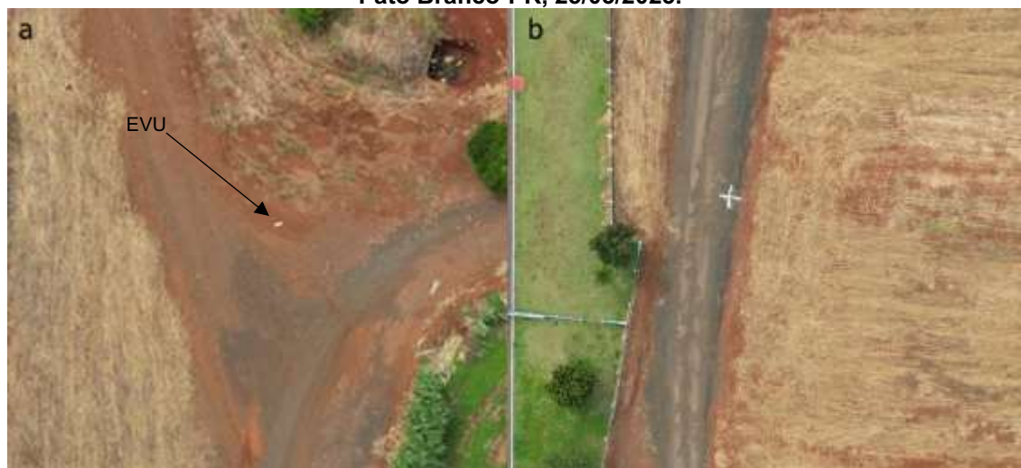
Figura 5 – Ponto de controle (a) confeccionado com EVU e (b) desenhado com cal sobre o solo. Pato Branco-PR, 25/03/2023.
