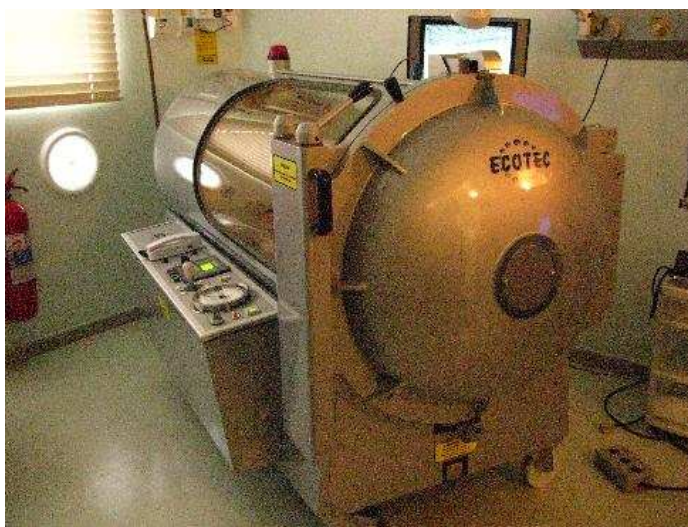
Figura 35 - Câmara Hiperbárica monoplace, ECOBAR 800. Fonte: autoria própria
