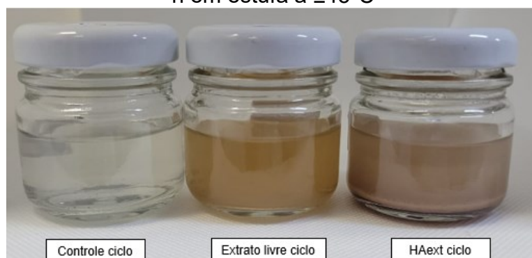
Figura 24 - Cor e aspecto das amostras dos ciclos de gelo e degelo no dia 3 após 24 h em estufa a \pm 45^{\circ}\text{C}
