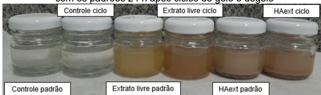
Figura 26 – Comparação de cor e aspecto das amostras dos ciclos de gelo e degelo com os padrões 24 h após ciclos de gelo e degelo
