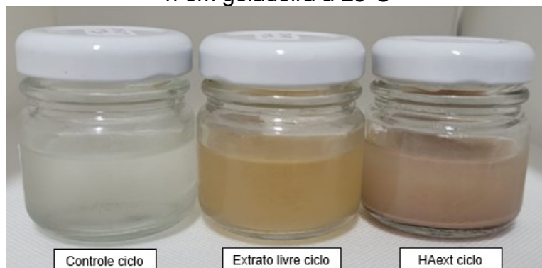
Figura 23 - Cor e aspecto das amostras dos ciclos de gelo e degelo no dia 2 após 24 h em geladeira a \pm 5^{\circ}\text{C}
