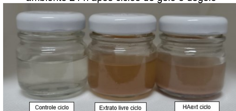
Figura 25 - Cor e aspecto das amostras dos ciclos de gelo e degelo em temperatura ambiente 24 h após ciclos de gelo e degelo
