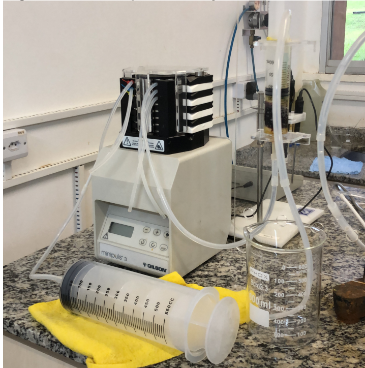
Figura 8: Leito fixo para introdução de S^{2-} na RTI
