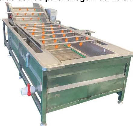
Figura 57 - Máquina de limpeza de bolhas para lavagem da fibra residual da polpa do maracujá.
