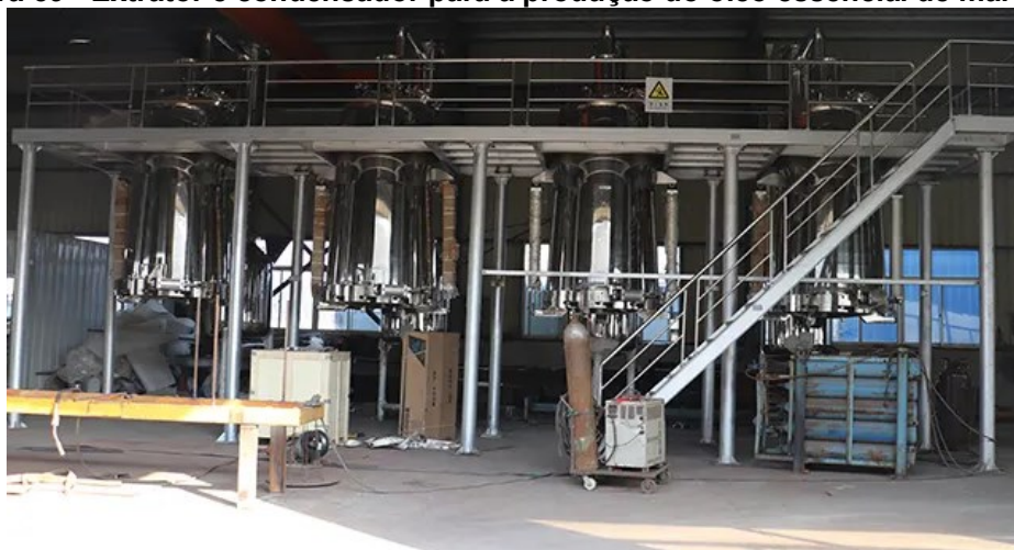
Figura 59 - Extrator e condensador para a produção do óleo essencial de maracujá.
