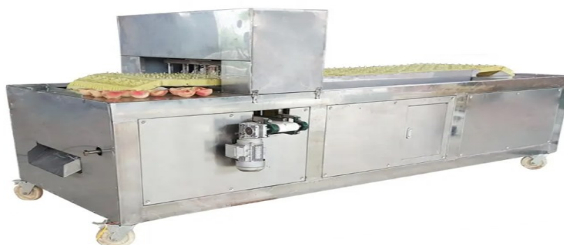
Figura 64 - Máquina separadora de semente utilizados para separar a amêndoa do tegumento de manga.
