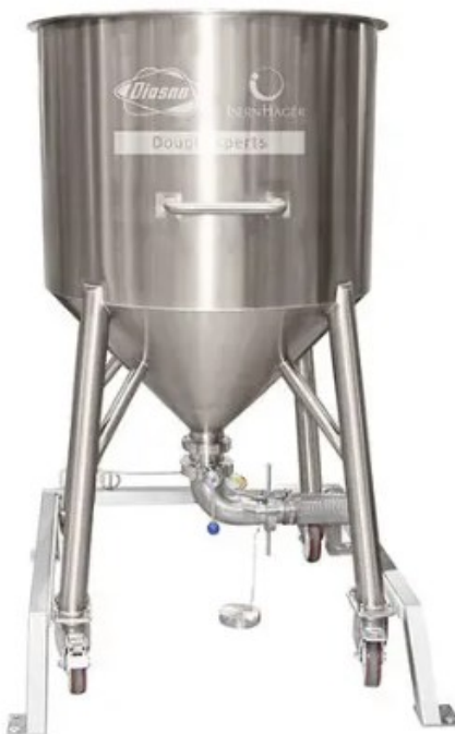
Figura 56 - Tanque de armazenamento de matéria-prima para a produção do óleo essencial de maracujá com capacidade de 600L.
