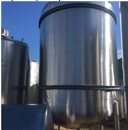
Figura 61 - Tanque de aço inox para o armazenamento do hidrolato.
