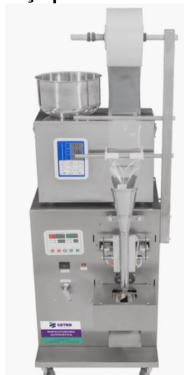
Figura 73 - Empacotadora de balança para embalar o xampu e condicionador Mangut .
