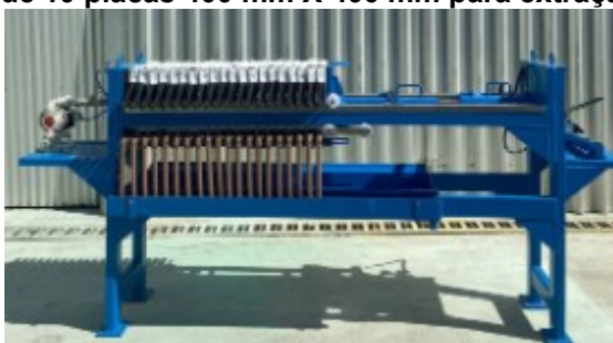
Figura 68 - Filtro prensa de 10 placas 400 mm X 400 mm para extração da manteiga de manga.
