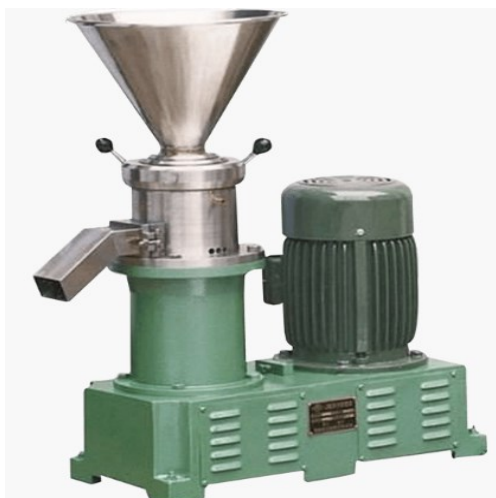
Figura 79 – Moinho utilizado para micronizar os resíduos sólidos.
