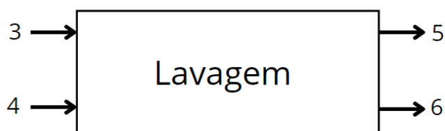
Figura 22 - Representação do lavador das fibras residuais da polpa do maracujá com as correntes de entrada e saída.
