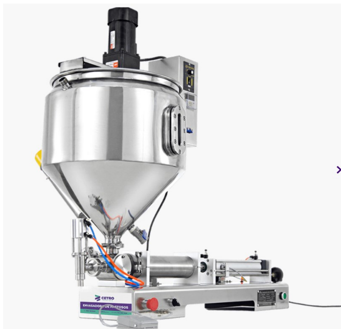
Figura 71 - Envasadora de produto pastoso utilizado no envase do xampu e condicionador Mangut .
