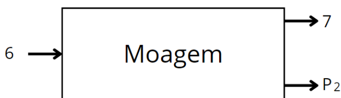
Figura 23 - Representação do processo de moagem das fibras residuais da polpa do maracujá com as correntes de entrada e saída.
