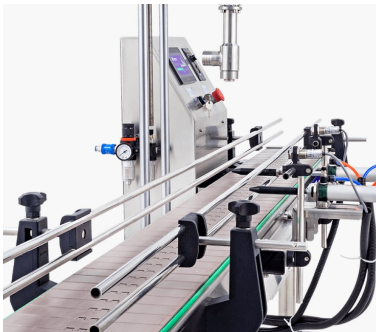
Figura 72 - Esteira transportadora com painel para utilizado na linha de produção do xampu e condicionador Mangut .
