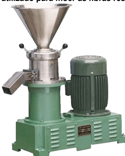
Figura 58 - Moinho CTS-120 utilizado para moer as fibras residuais da polpa do maracujá.
