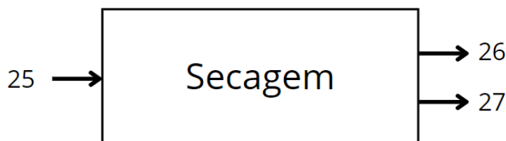
Figura 35- Representação do processo de secagem das amêndoas de manga com as correntes de entrada e saída.
