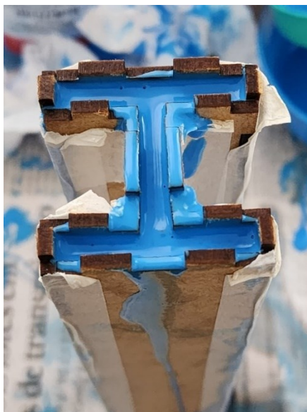
Figura 4.36 – Moldagem da viga de silicone.
