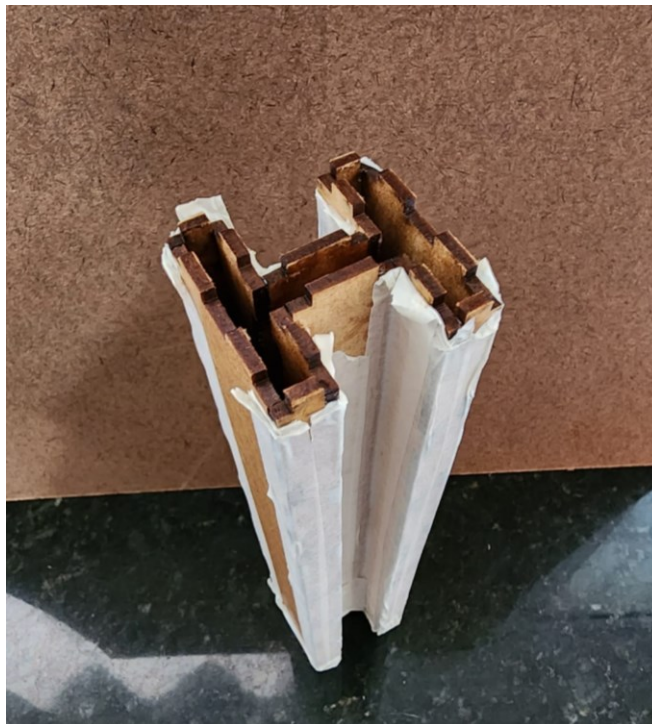
Figura 4.34 – Molde da viga de silicone montado.
