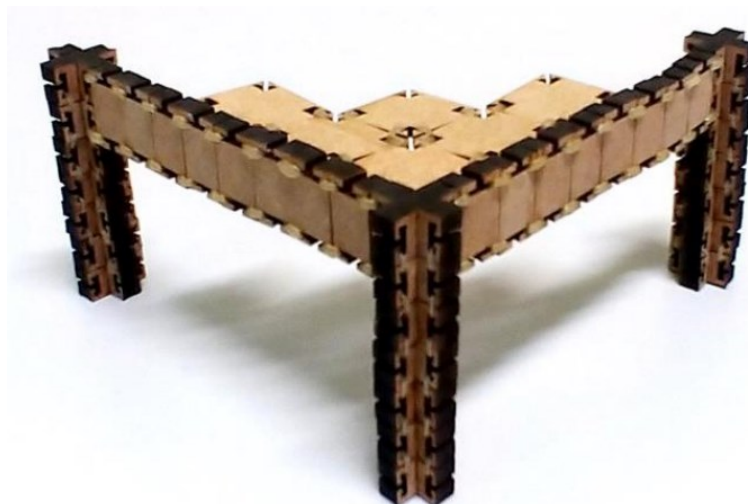
Figura 2.9 - Montagem do protótipo final demonstrando a construção de pilares vigas e lajes.
