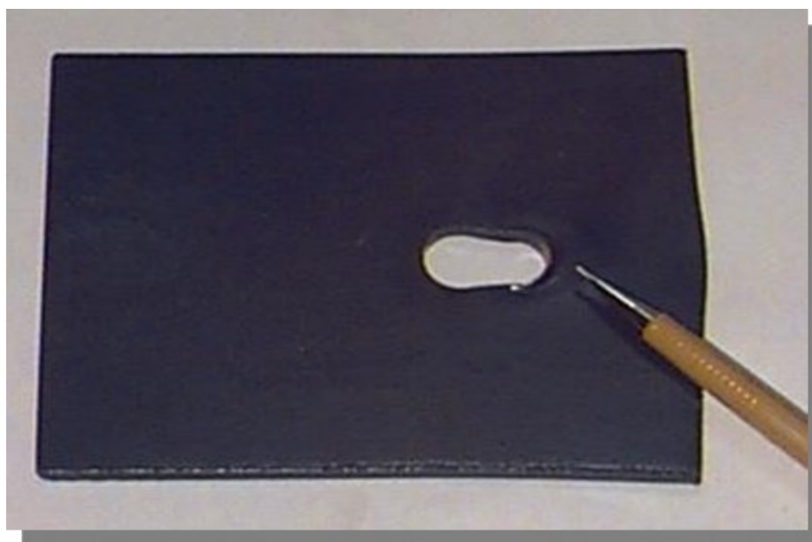
Figura 4.12 – Chapa de aço com deformação excessiva do furo (esmagamento).
