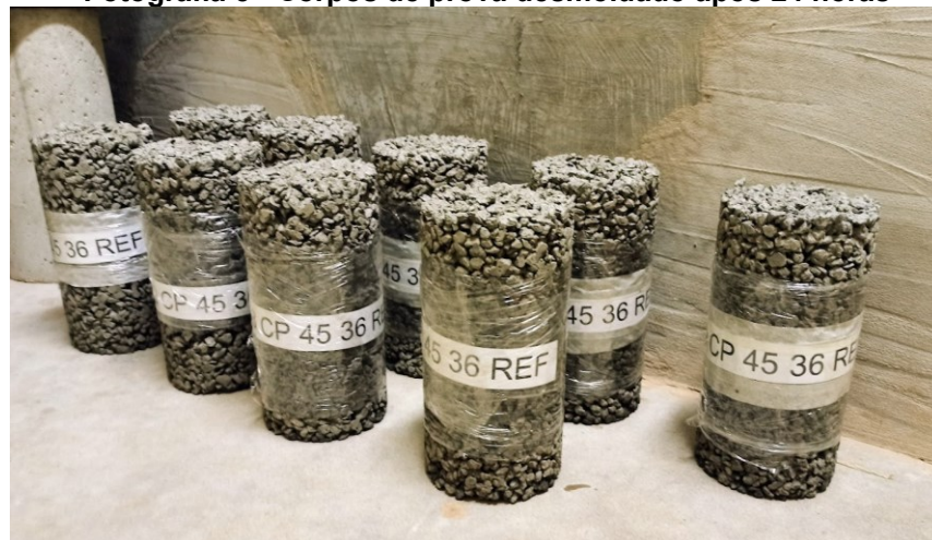
Fotografia 5 - Corpos de prova desmoldado após 24 horas
