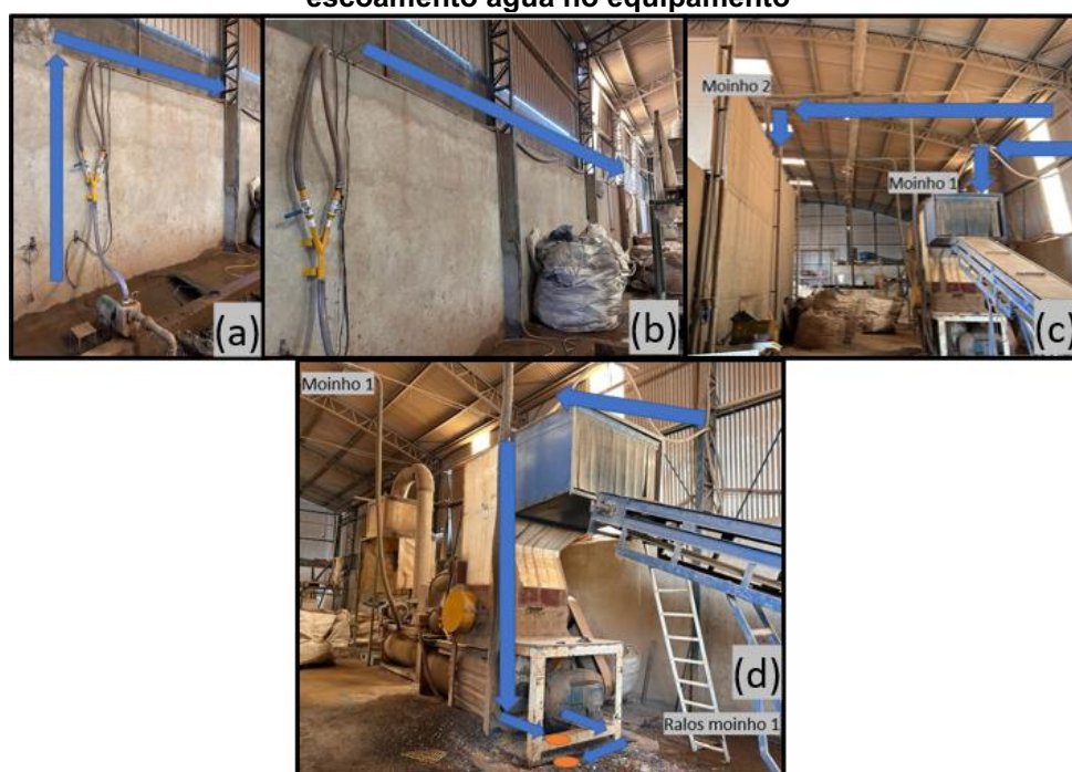
Figura 9 -Representação do ciclo fechado da água de reuso com (a) início percurso da água de reuso; (b)caminho percorrido; (c) chegada parte superior dos moinhos; (d) representação escoamento água no equipamento
