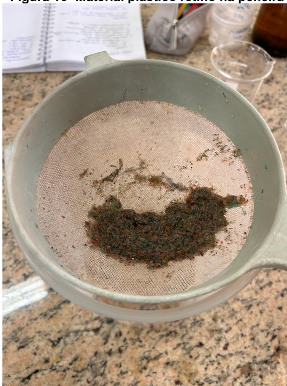
Figura 16- Material plástico retino na peneira
