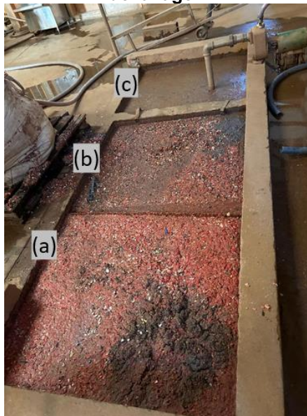
Figura 11- Caixas de decantação (a) 1, (b) 2 e (c) 3, em série, usadas para o tratamento da água de lavagem
