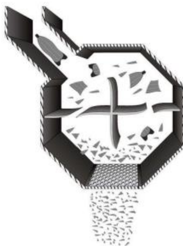
Figura 5- Representação de moagem de moinho de facas
