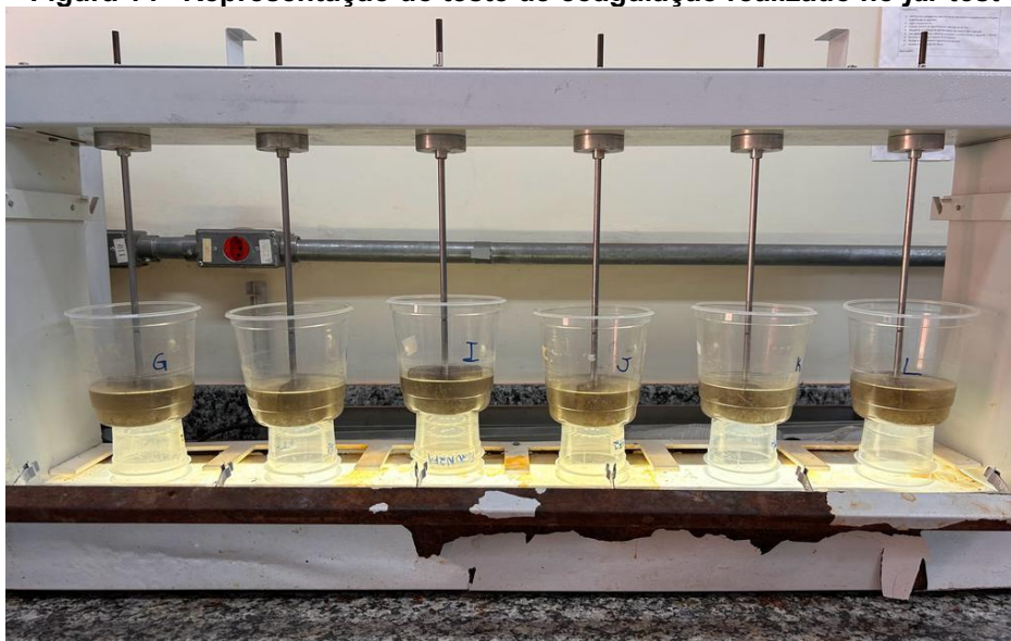
Figura 14– Representação do teste de coagulação realizado no jar test
